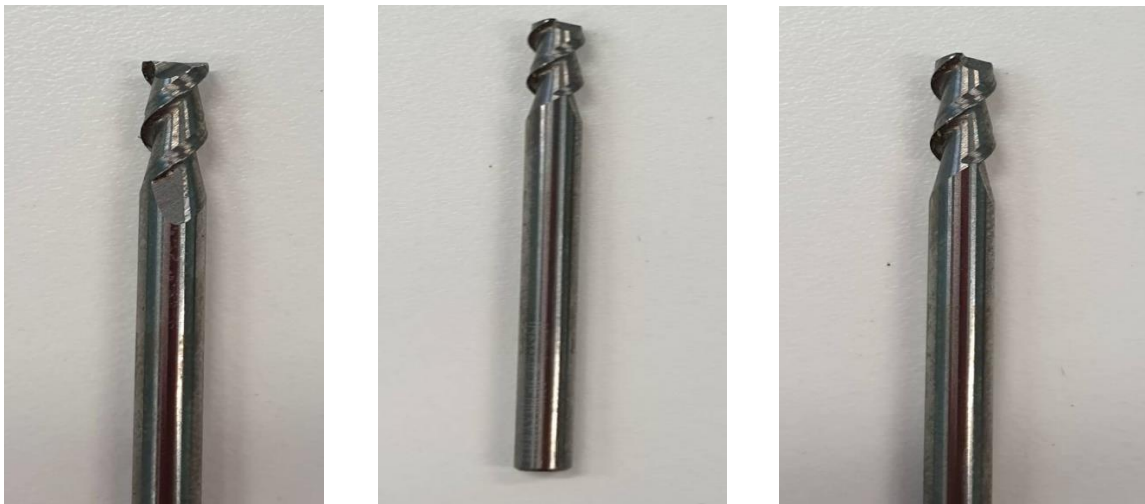
Slika 4.8. Glodala od 3mm s 2 pera
