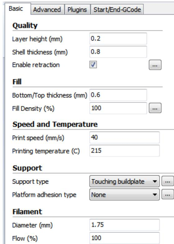
Slika 5.9. Namještanje parametara 3D printer-a
