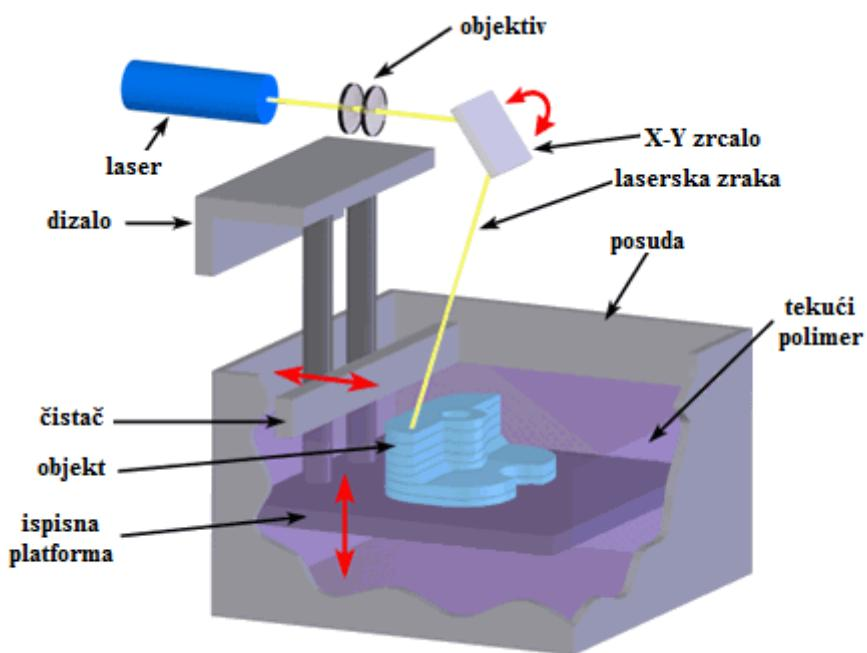
Slika 3.3. Stereolitografija [24]
