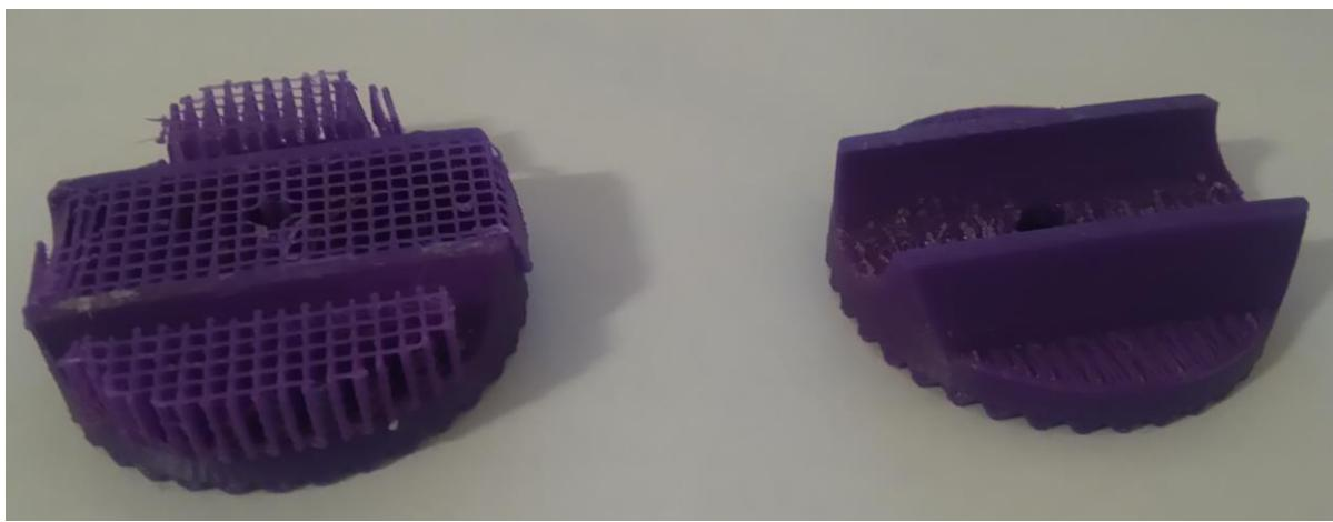
Slika 5.16. Uklanjanje potporne strukture
