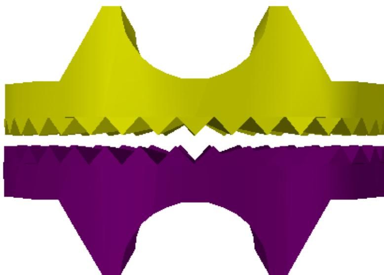
Slika 5.7. CAD model spojnice br.1 i spojnice br.2
