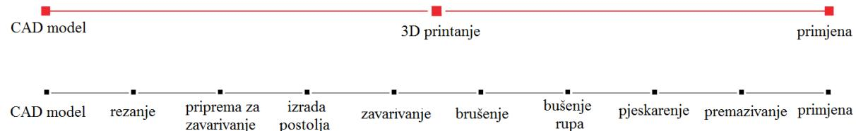
Slika 4.2. Usporedba 3D tiskanja i tradicionalnih postupaka obrade [34]
