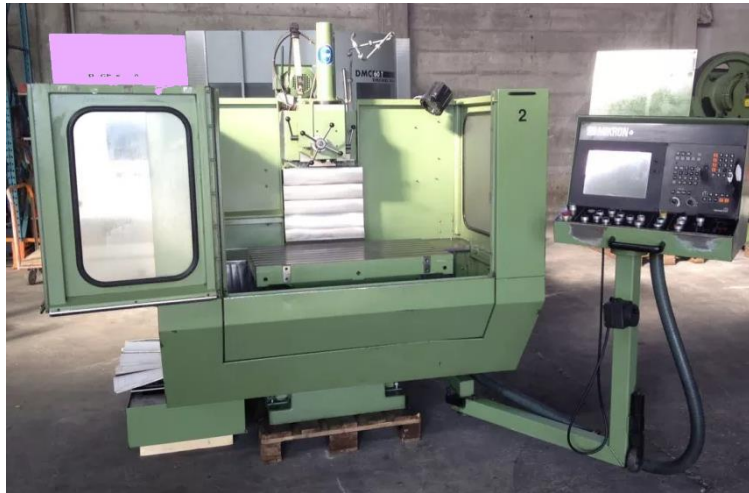
Slika 5.4 Glodalica MIKRON WF 31 D.
