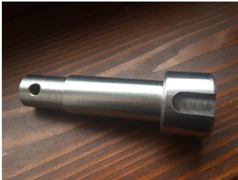
Slika 4.21 Konačni izgled vratila
