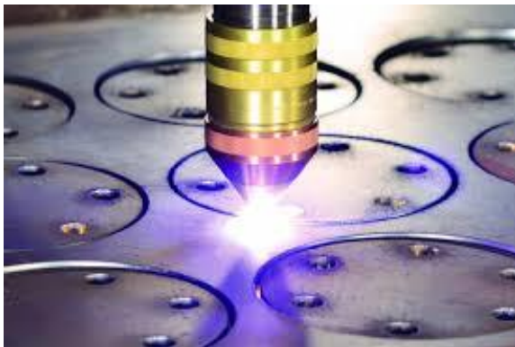
Slika 4.5 Načini piljenja metala: a) tračno piljenje, b) kružno piljenje, c) lasersko piljenje, d) piljenje vodenim mlazom
