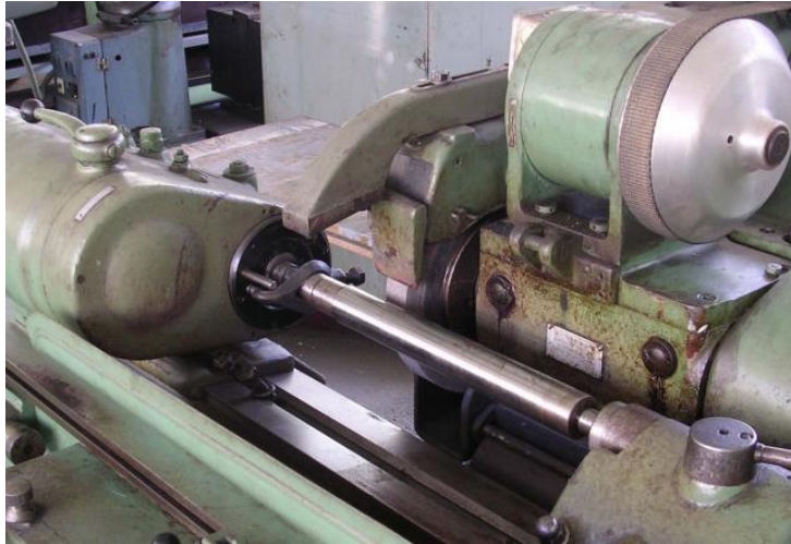
Slika 4.17 Vanjsko obodno okruglo brušenje
