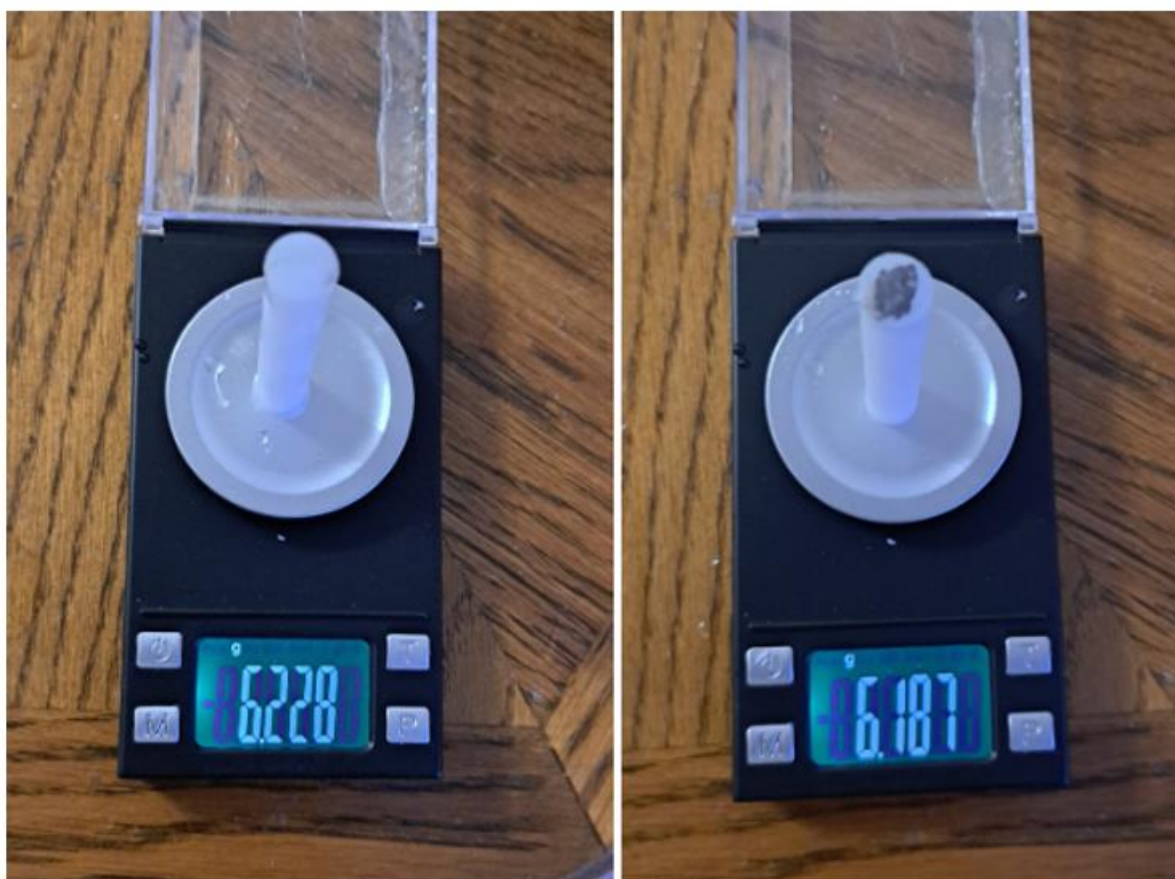
Slika 10 Rezultati mjerenja poliamida PA 6 petog dana
