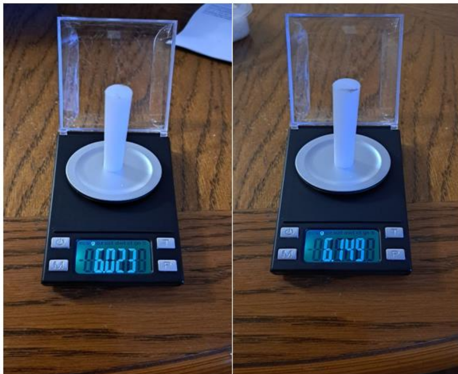
Slika 6 Rezultati početnog mjerenja poliamida PA 6
