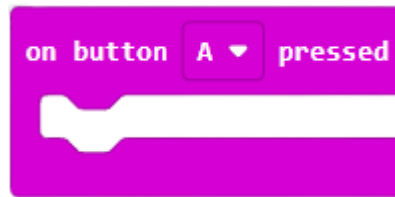
Slika 10. Programski kod potreban za prilagodbu tipkala A u svrhu početka rada senzora
