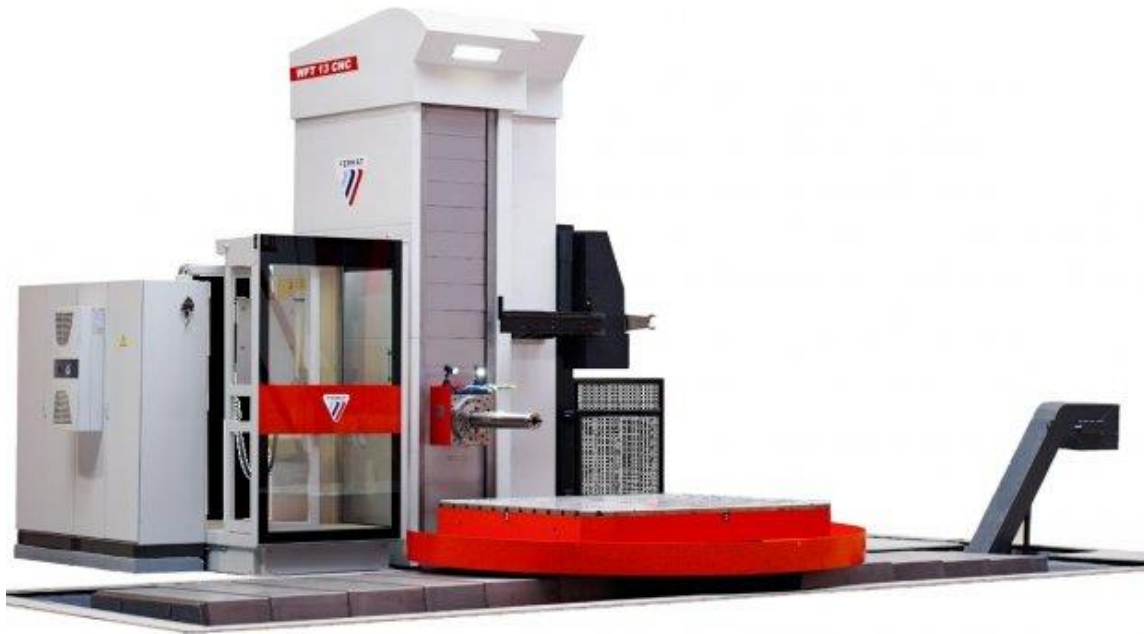
Slika 6.3. Horizontalni glodači obradni centar
