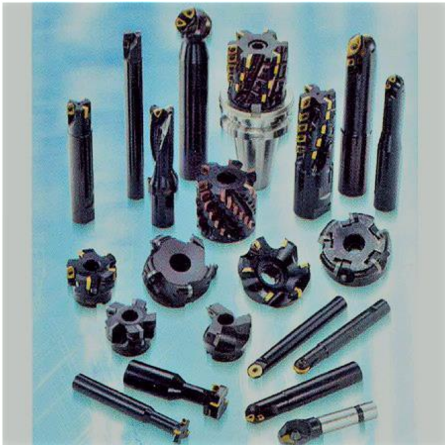
Slika 2.6. Glodala s umetnutim reznim oštricama
