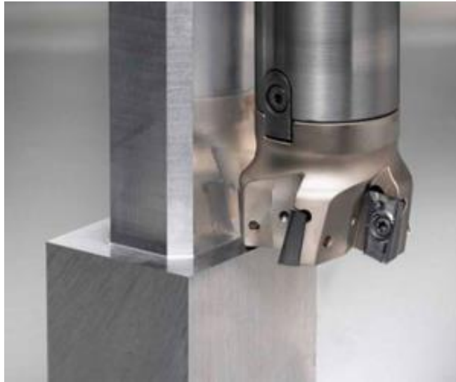
Slika 2.4. Čeono glodanje pravih kutova
