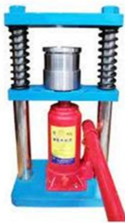
Slika 8. Sadržaj četvrtoog slajda prezentacije – hidraulična preša
