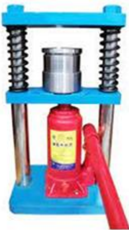
Slika 8. Sadržaj četvrtog slajda prezentacije – hidraulična preša
