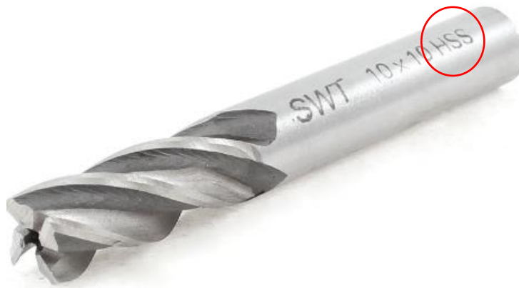
Slika 6. Utisnuta oznaka brzoreznog čelika u alatu
