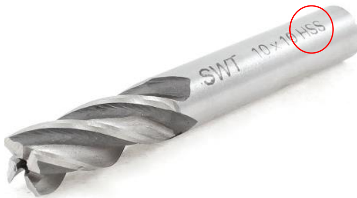
Slika 6. Utisnuta oznaka brzoreznog čelika u alatu
