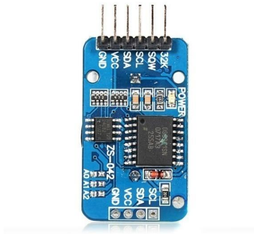
Slika 3.4 Mjerač vremena DS3231 [18].
