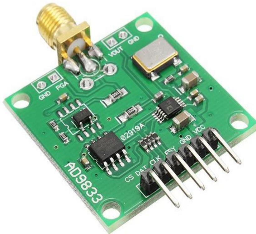
Slika 13: Modul AD9833 generatora digitalnog signala koji se povezuje na računalo [10]
