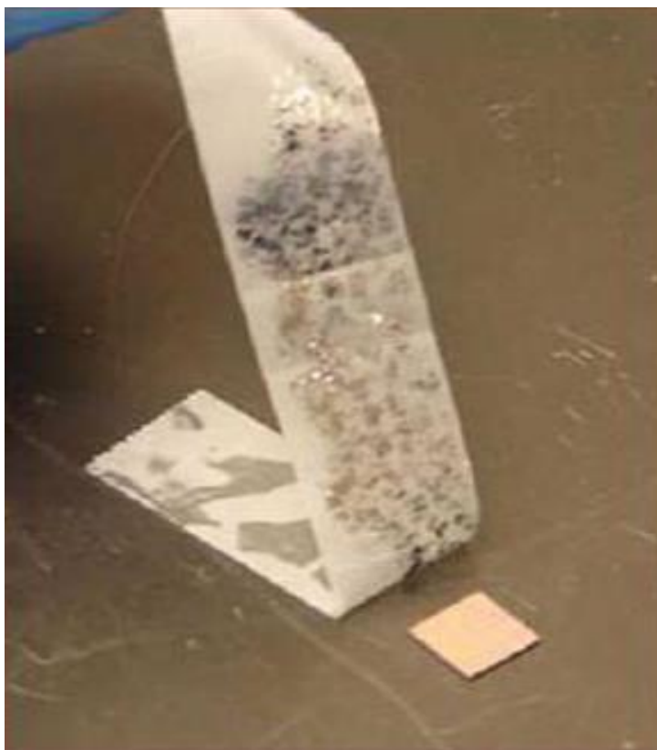
Slika 1. Izolirana izolacija grafena iz grafita [1]
