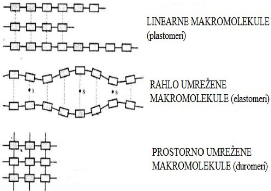
Slika 6. Shematski prikaz makromolekularne strukture polimernih materijala [4]
