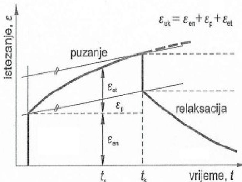
Dijagram 3. Prikaz ponašanja polimernog materijala pri dugotrajnom statičkom opterećenju [2]
