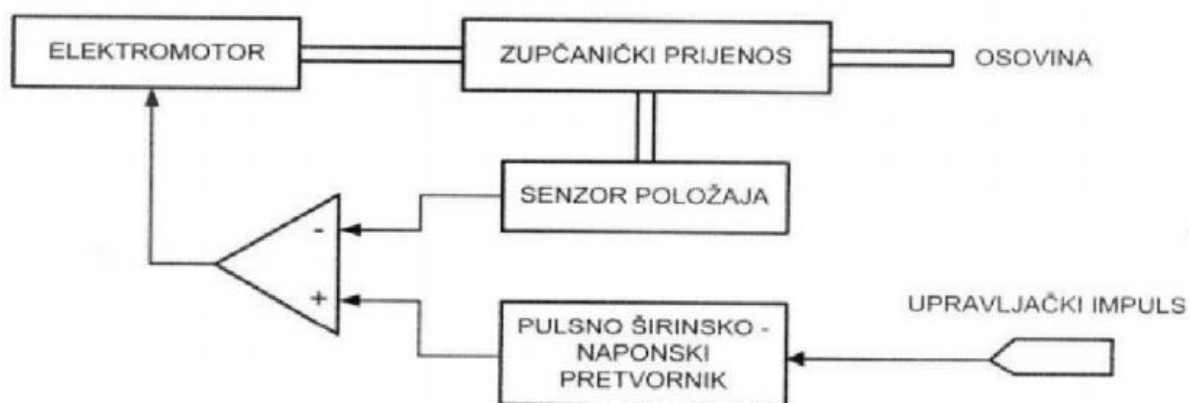
Slika 15. Blok dijagram sustavnih dijelova servo motora [13]
