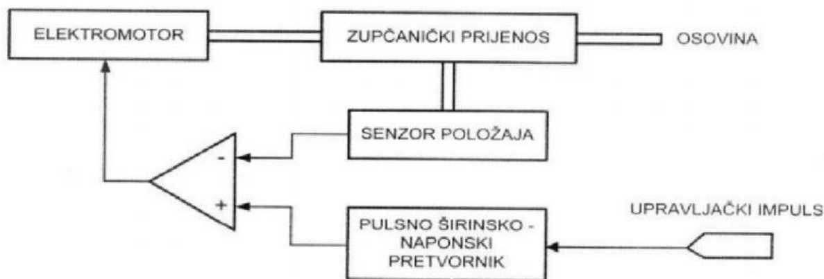
Slika 15. Blok dijagram sustavnih dijelova servo motora [13]
