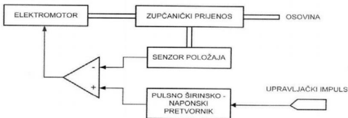
Slika 15. Blok dijagram sustavnih dijelova servo motora [13]
