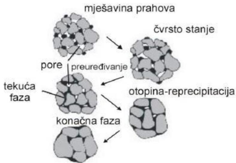
Slika 20 : Prikaz razina sinteriranja u tekućoj fazi [4.]
