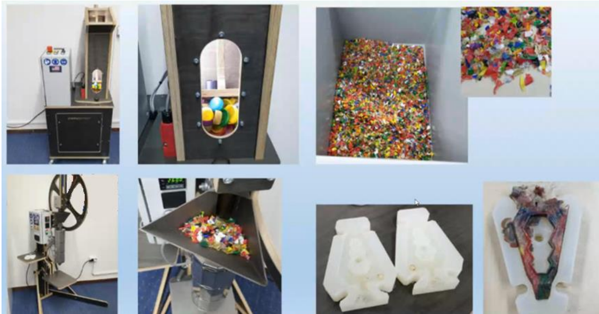
Slika 9. EKO ekstruder- mljevenje čepova , kalup izrađen 3D printerom i lijevanje u kalup recikliranom plastikom
