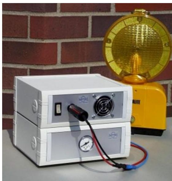
Slika 8. Prototip prijenosnog gorivog članka snage 50W [1].
