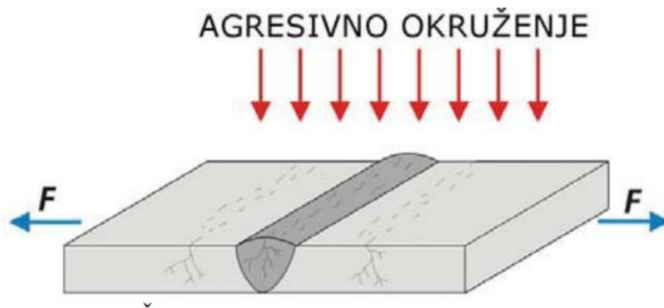
Slika 5.12. Nastanak napetosne korozije [17]
