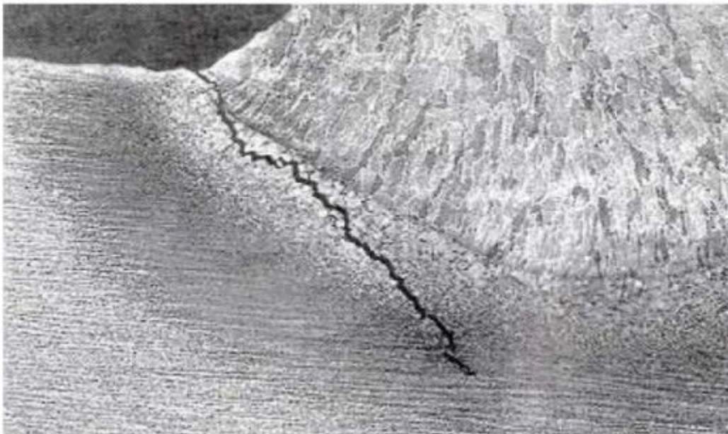
Slika 3.3. Nastajanje hladne pukotine [6]
