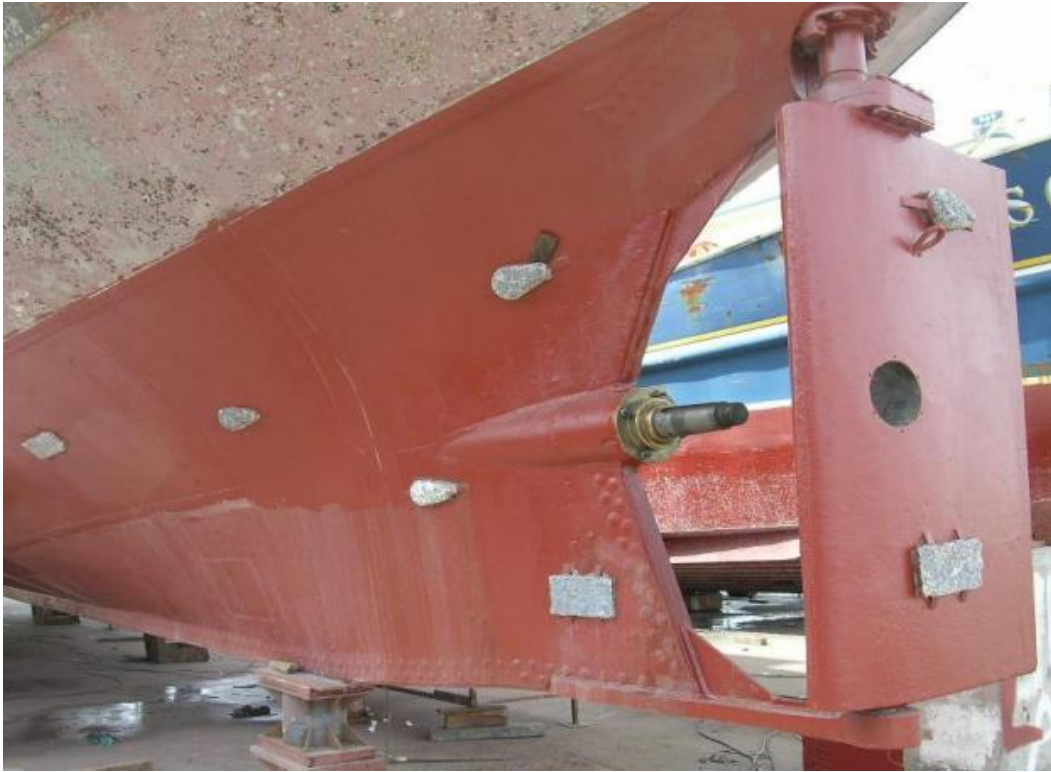
Slika 7.4. Žrtvene Anode na brodu [5]
