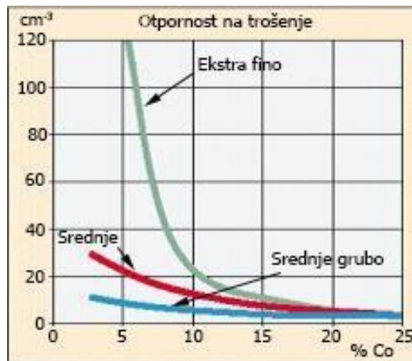
Slika 4.3 Otpornost na trošenje u funkciji udjela Co i veličine WC zrna [15]
