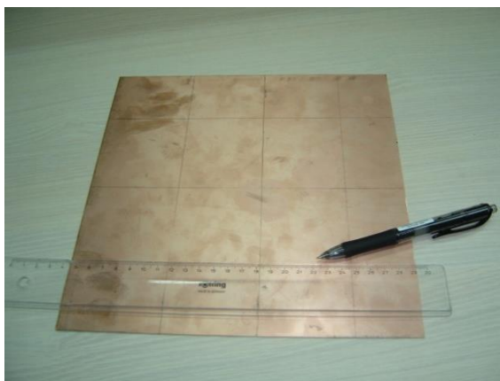
Slika 4.1. O crtavanje gabarita pločice
