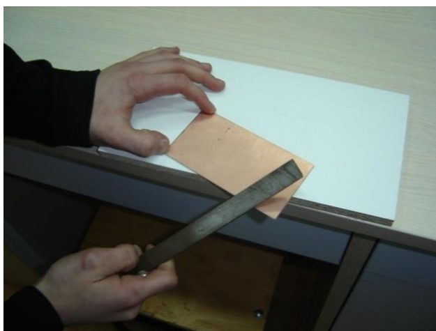
Slika 4.3. Uređivanje bridova pločice pločice
