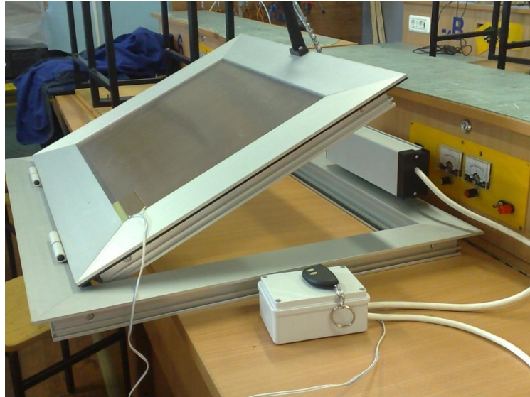
Slika 2.8. Prozor sa sustavom upravljanja
