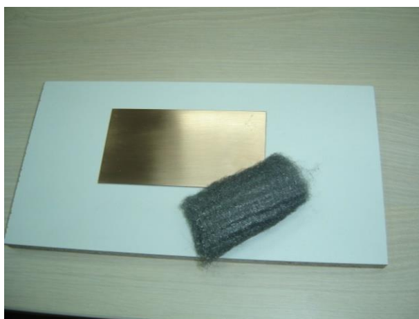
Slika 4.4. Čišćenje bakrene površine
