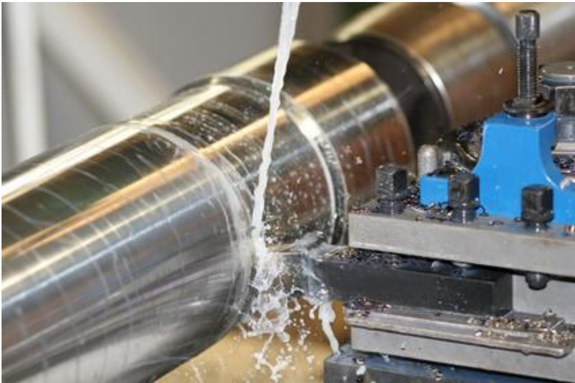
Slika 1.14 Tokarenje s vanjskom primjenom SHIP-a [4]
