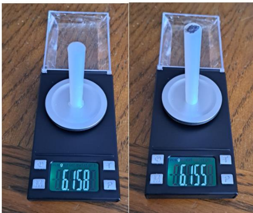
Slika 8 Rezultati mjerenja poliamida PA 6 drugog dana
