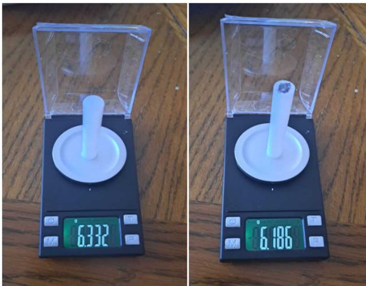
Slika 15 Rezultati mjerenja poliamida PA 6 dvadeset i osmog dana
