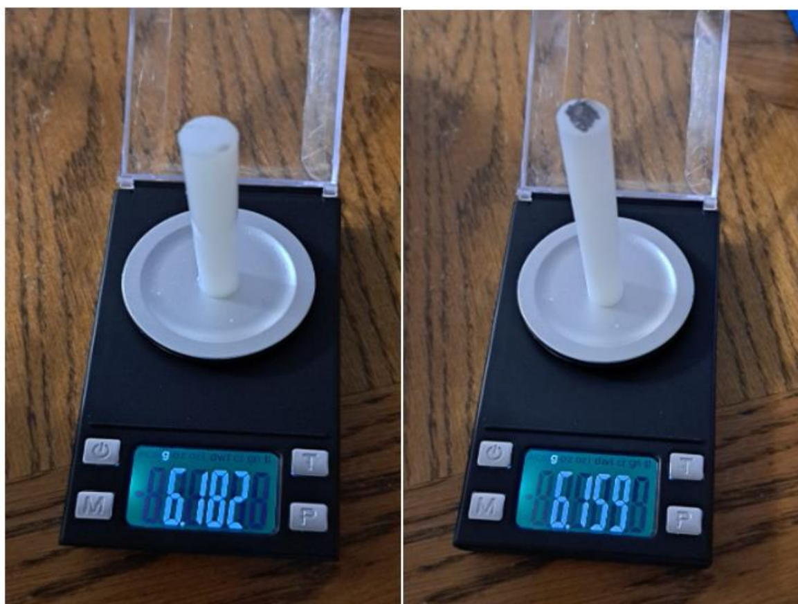
Slika 9 Rezultati mjerenja poliamida PA 6 trećeg dana
