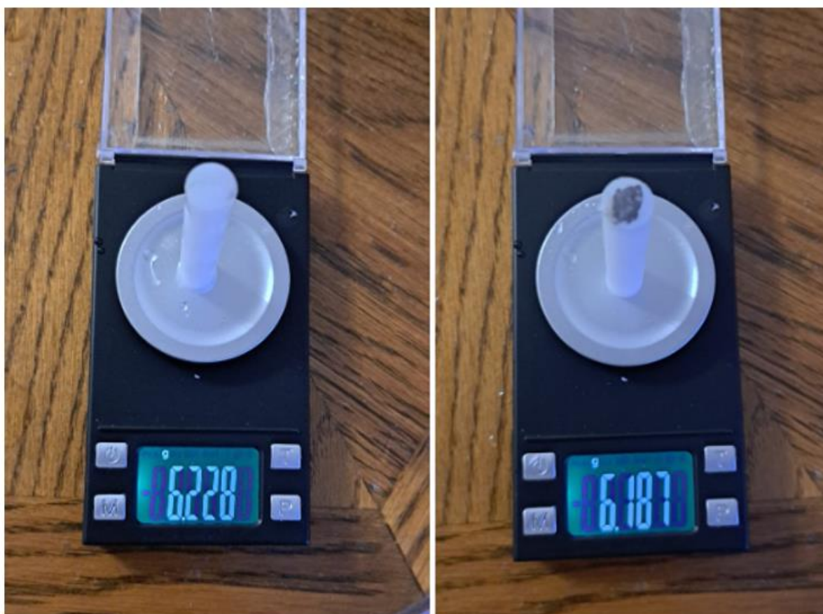
Slika 10 Rezultati mjerenja poliamida PA 6 petog dana
