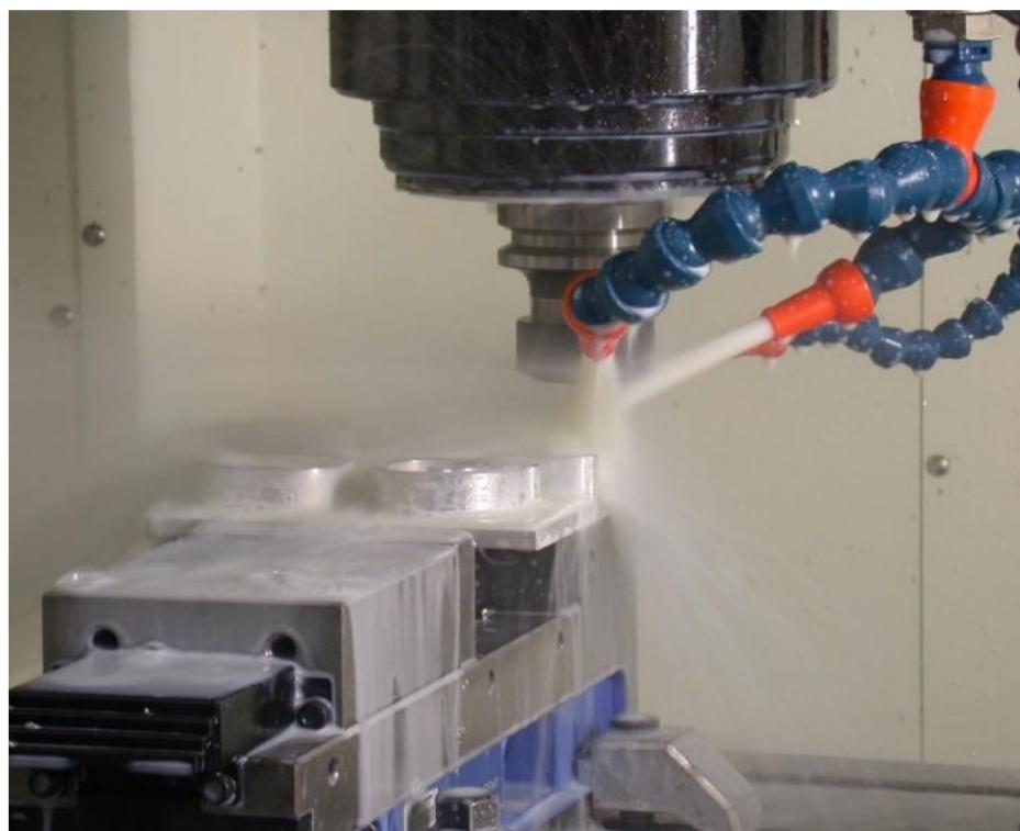
Slika 5.1. Vanjska primjena SHIP-a [8]
