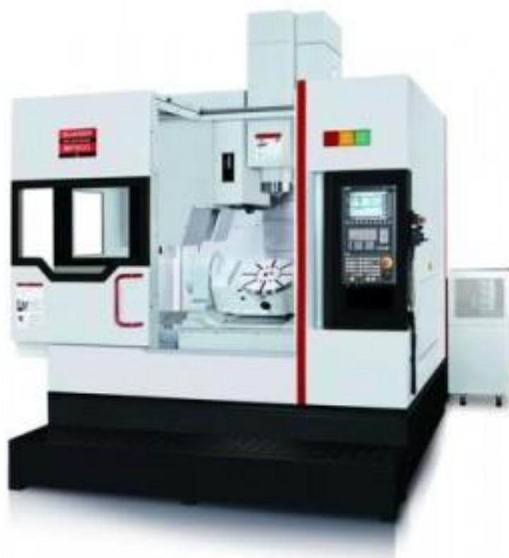
Slika 6.4. 5 - osni glodaći obradni centar
