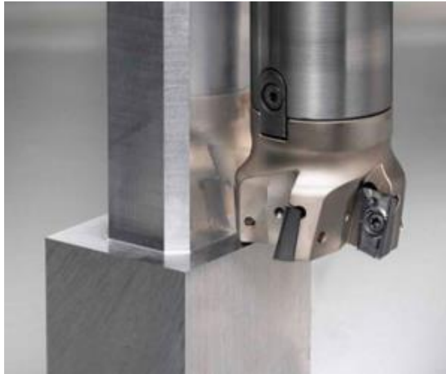
Slika 2.4. Čeono glodanje pravih kutova
