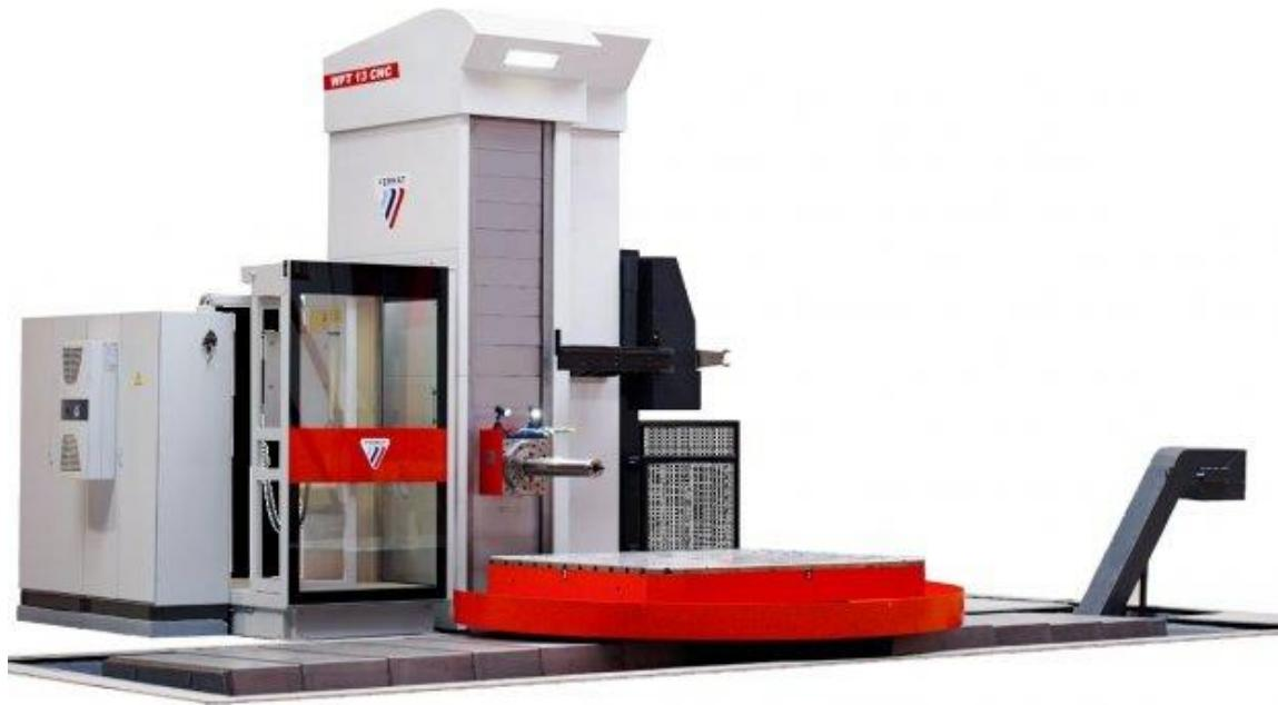
Slika 6.3. Horizontalni glodaći obradni centar
