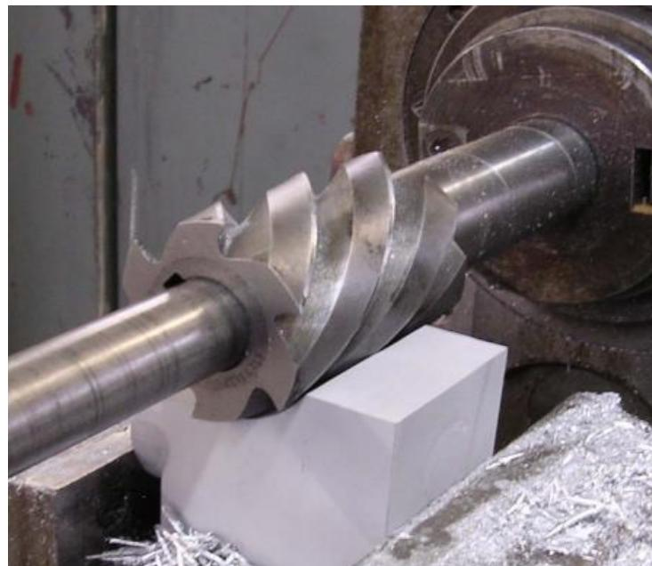
Slika 2.3. Istosmjerno [2]
