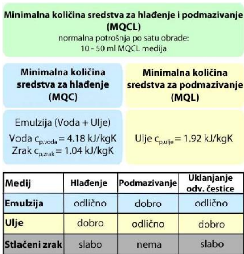
Slika 5.5. Svojstva MQCL obrade [6]
