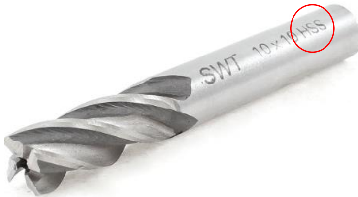
Slika 6. Utisnuta oznaka brzoreznog čelika u alatu
