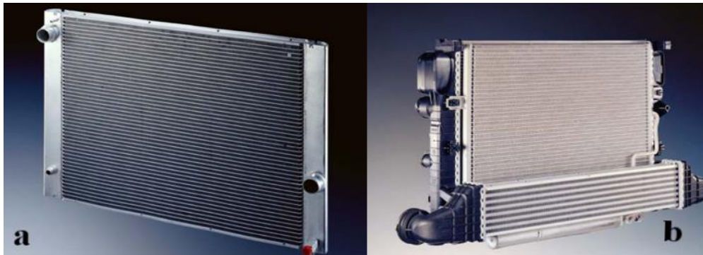
Slika 6. Primjer radijatora a) potpuno od aluminija, b) s plastičnim spremnikom [13]
