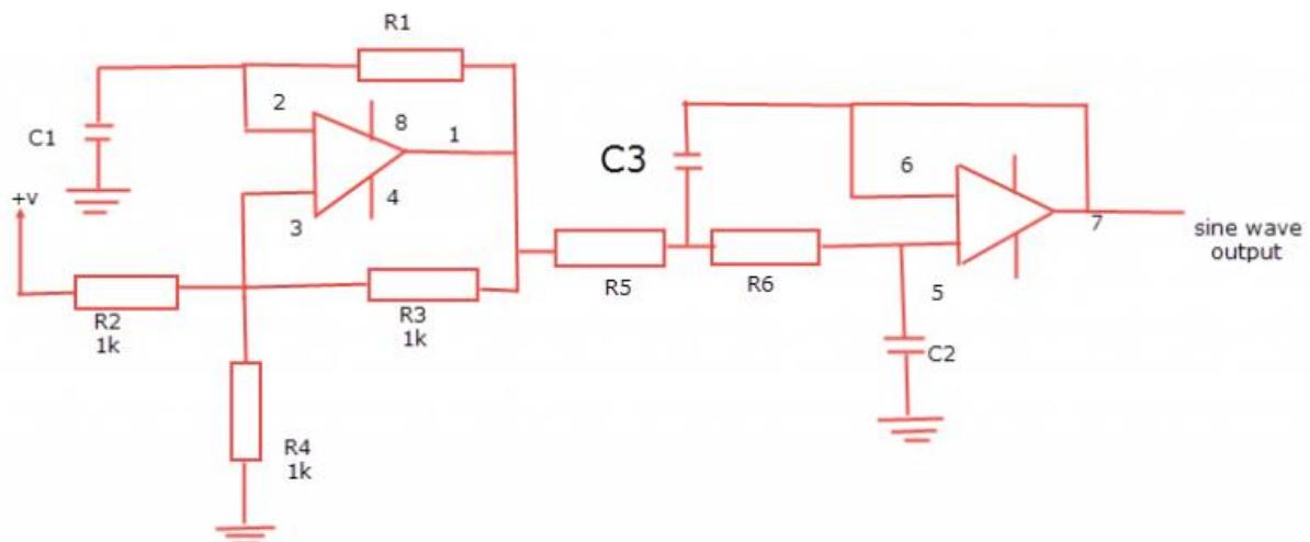
Slika 10: Blok dijagram generatora sinusnog signala [4]
