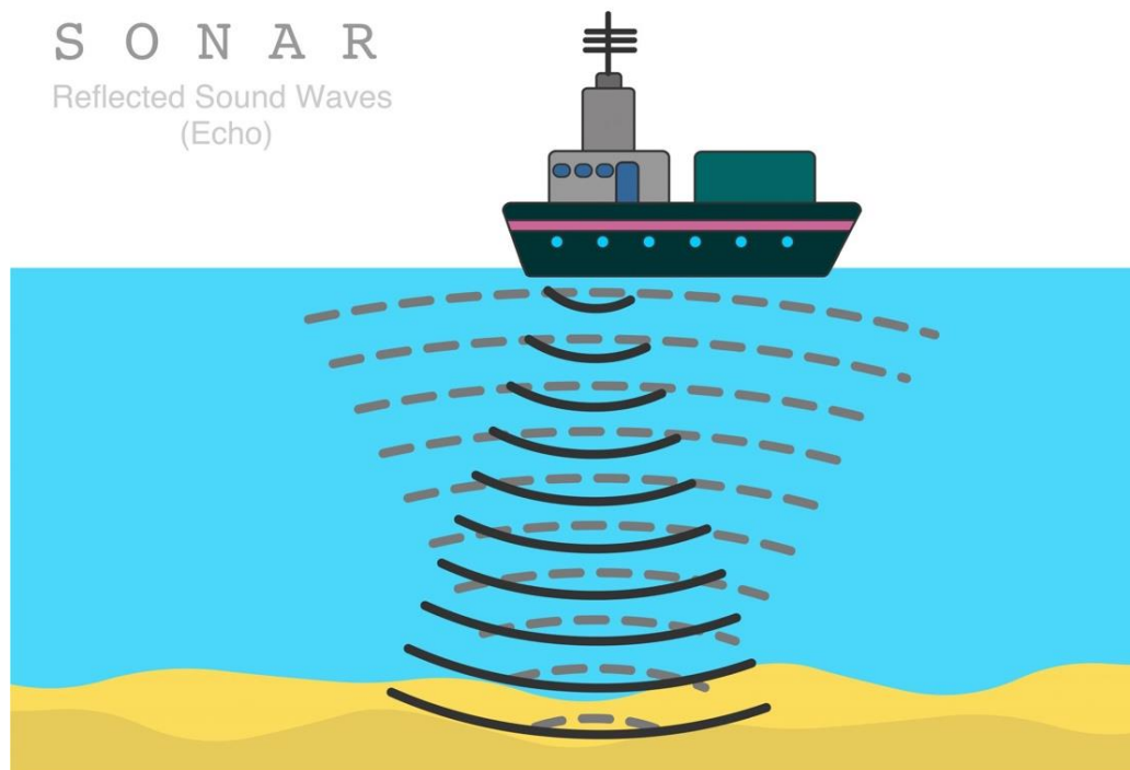
Slika 1. Princip odašiljanja i zaprimanja signala sonara. Izvor https://www.americanocéans.org/facts/what-is-sonar/ [3]
