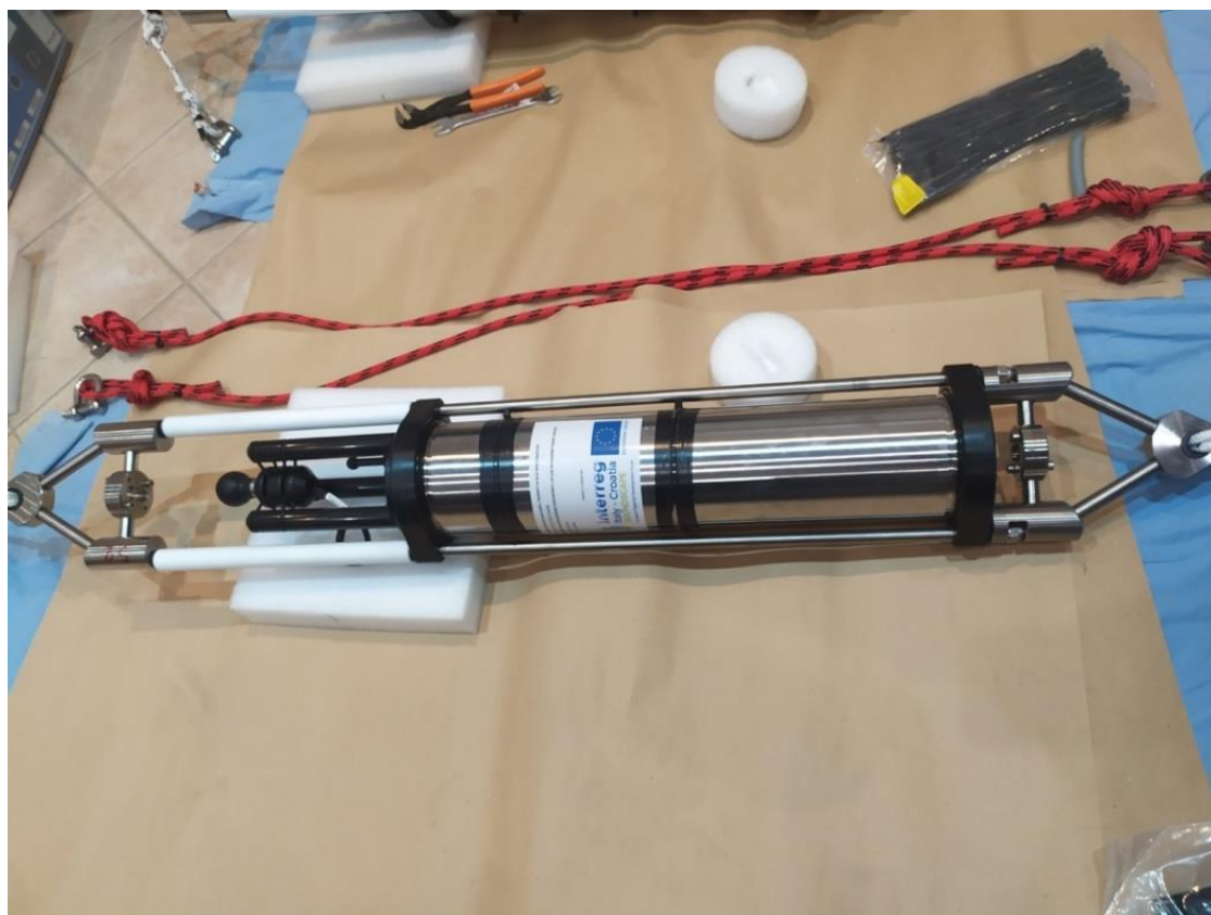
Slika 4. Hidrofon – podvodni mikrofoni – služi za snimanje podvodnih zvukova. Izvor https://www.plavi-svijet.org/soundscape-the-equipment-testing-for-the-underwater-noise-acoustic-monitoring/ [16]
