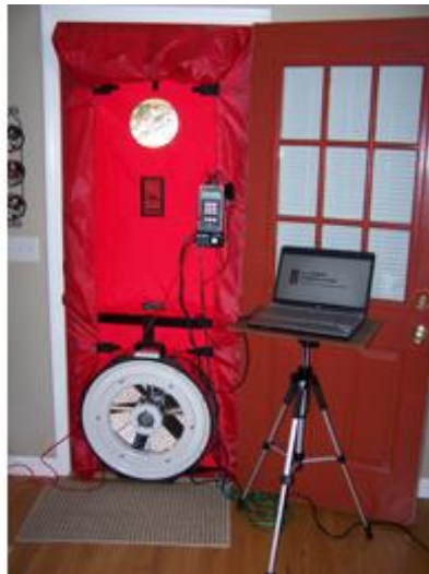
Slika 15. Izvođenje Blower Door testa [27].
