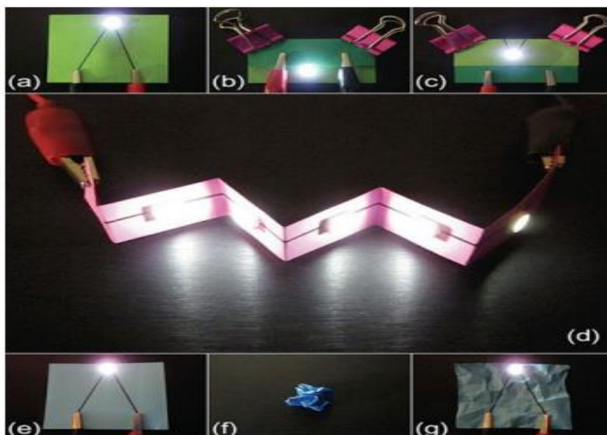
Slika 9. Savitljivi strujni krug na bazi grafena [4]
