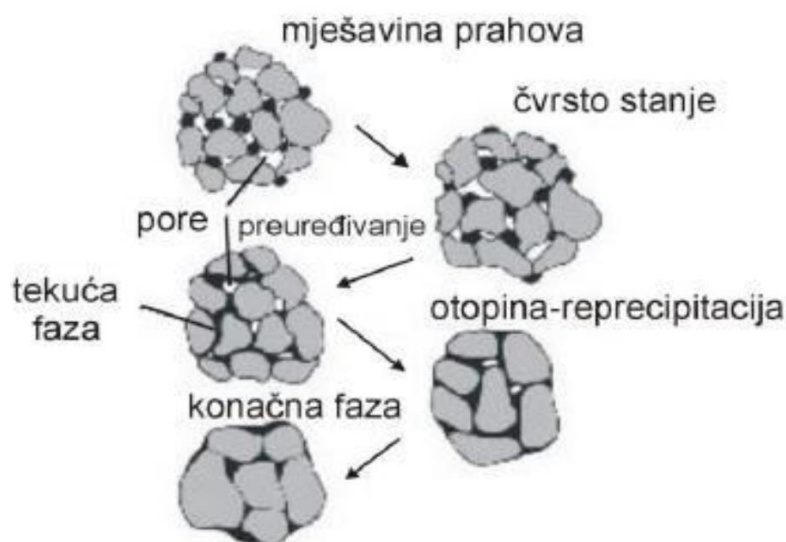
Slika 20 : Prikaz razina sinteriranja u tekućoj fazi [4.]
