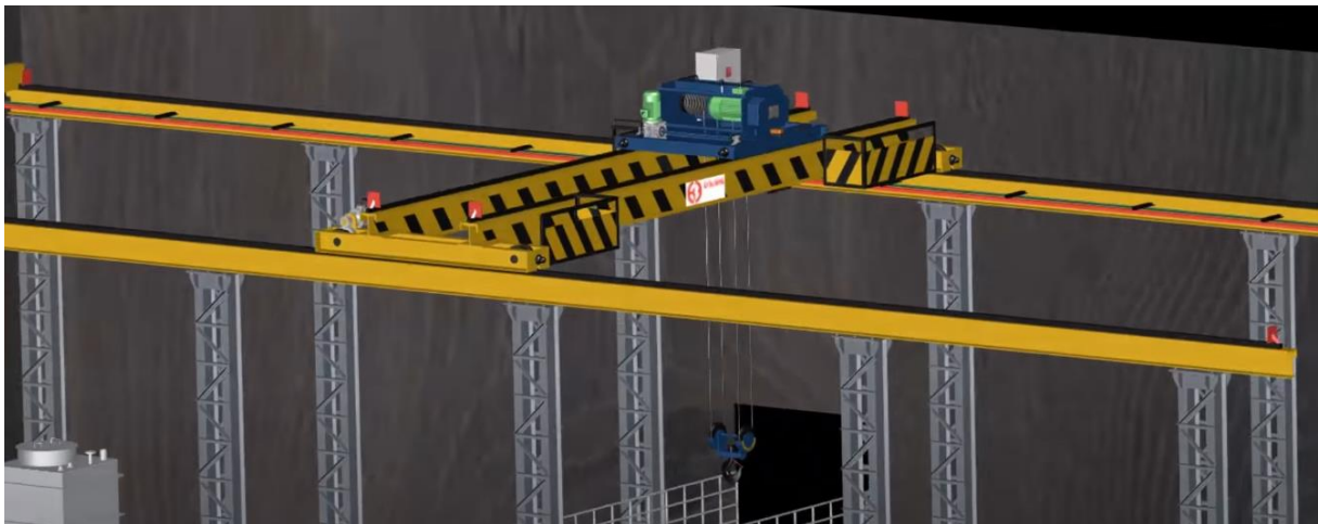
Slika 24. Prikaz vozne staze sa kranskim mostom u sredini
