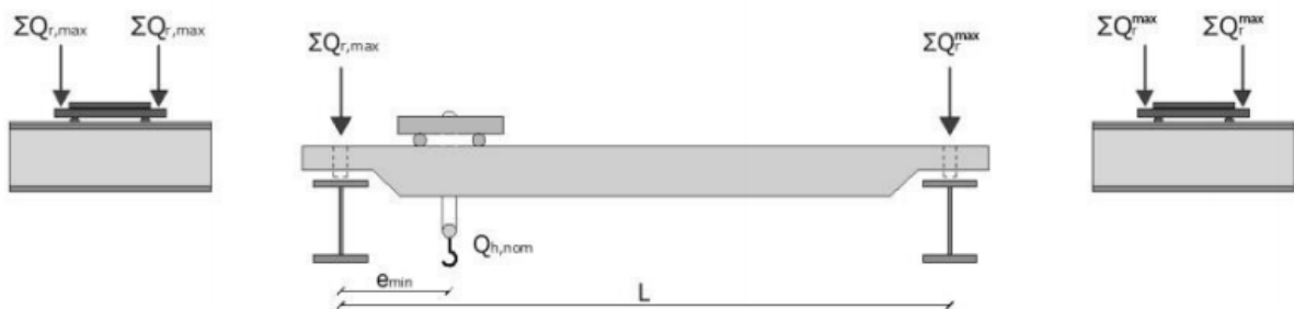
Slika 4. Prikaz opterećenja u slučaju kad je kran najviše opterećen
