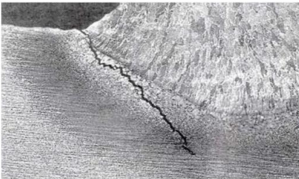
Slika 3.3. Nastajanje hladne pukotine [6]
