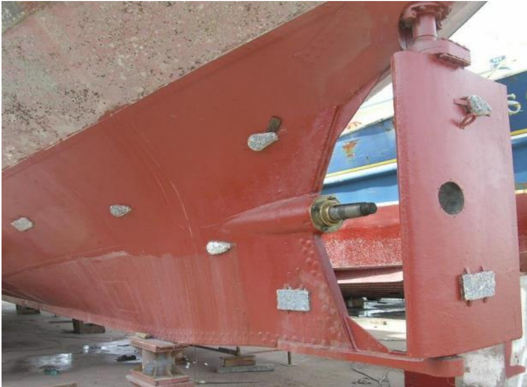
Slika 7.4. Žrtvene Anode na brodu [5]
