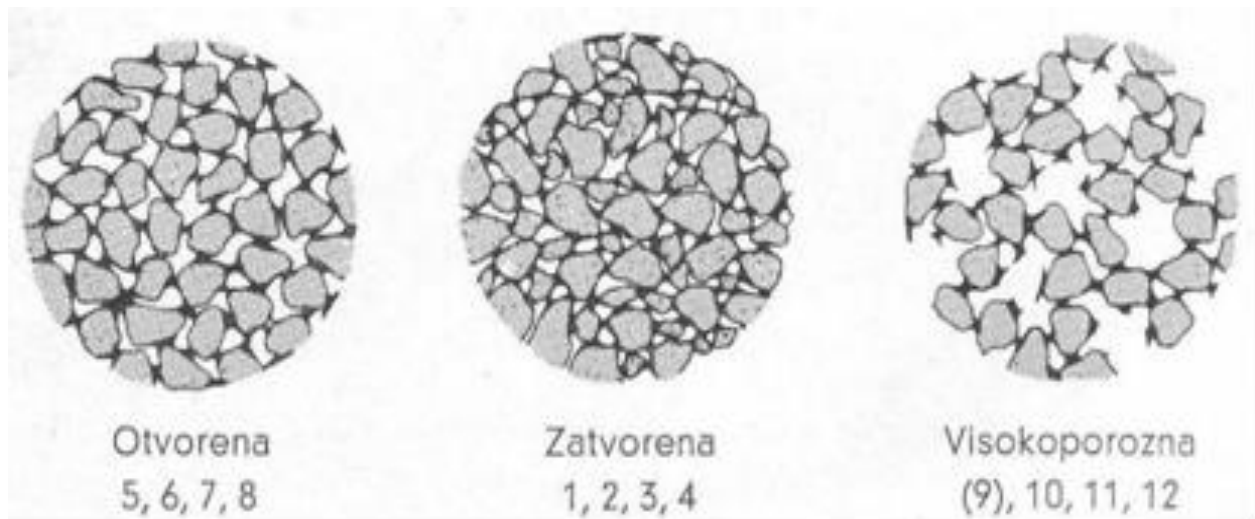
Slika 7. Struktura brusnih ploča
