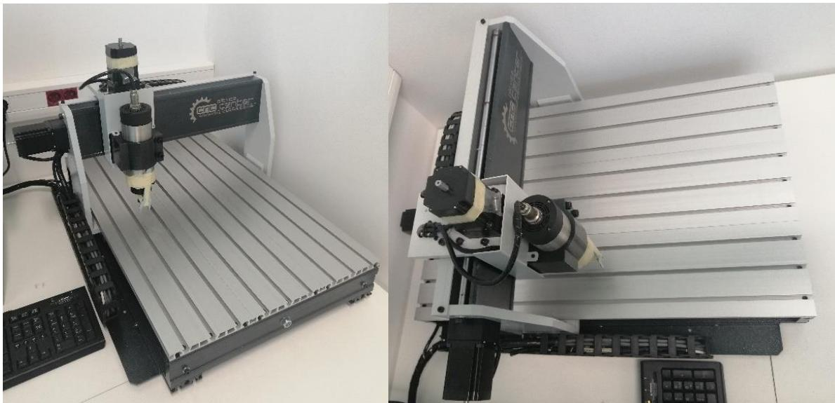
Slika 5.1. i 5.2. Vertikalna glodalica
