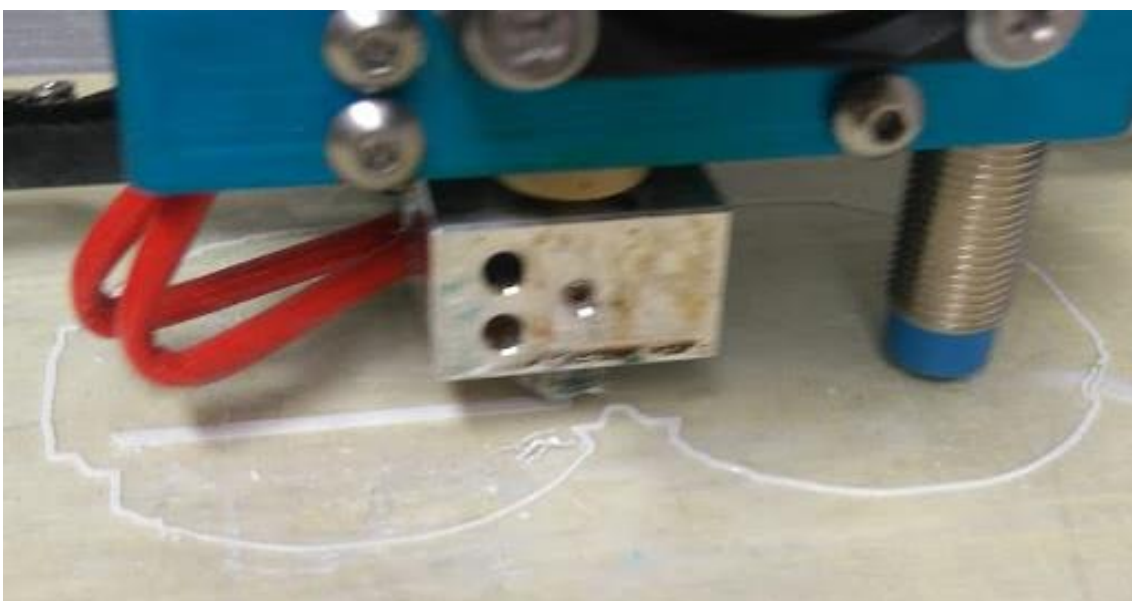
Slika 5.13. Početak 3D printanja
