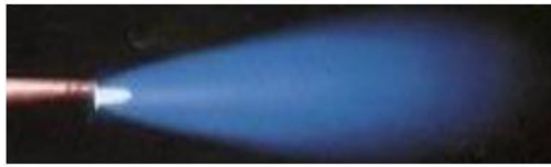
Slika 3.4. Prikaz neutralnog plamena[4]
