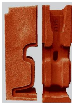
Slika 4.2. Oblici vatrostalnog kalupa [15]
