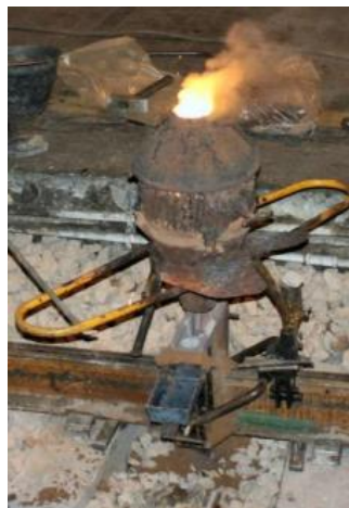
Slika 4.3. Prikaz tradicionalnog lonca (zvanog tigl) [15]
