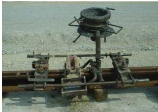
Slika 4.10. Prikaz opreme s loncem za zavarivanje [9]
