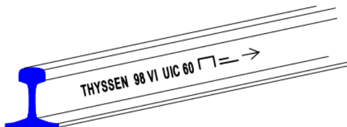
Slika 2.8. Opis oznaka na vratu tračnice [6]
