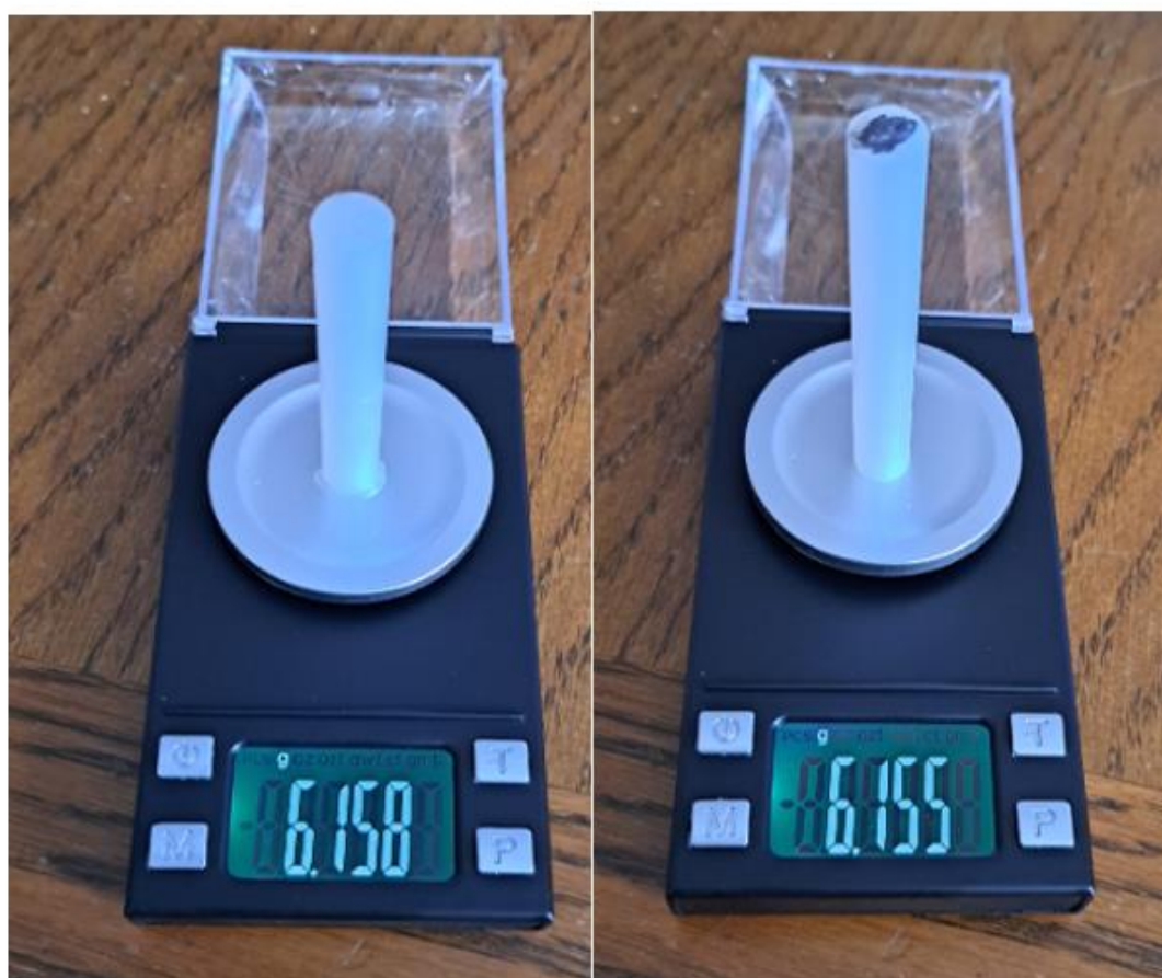
Slika 8 Rezultati mjerenja poliamida PA 6 drugog dana
