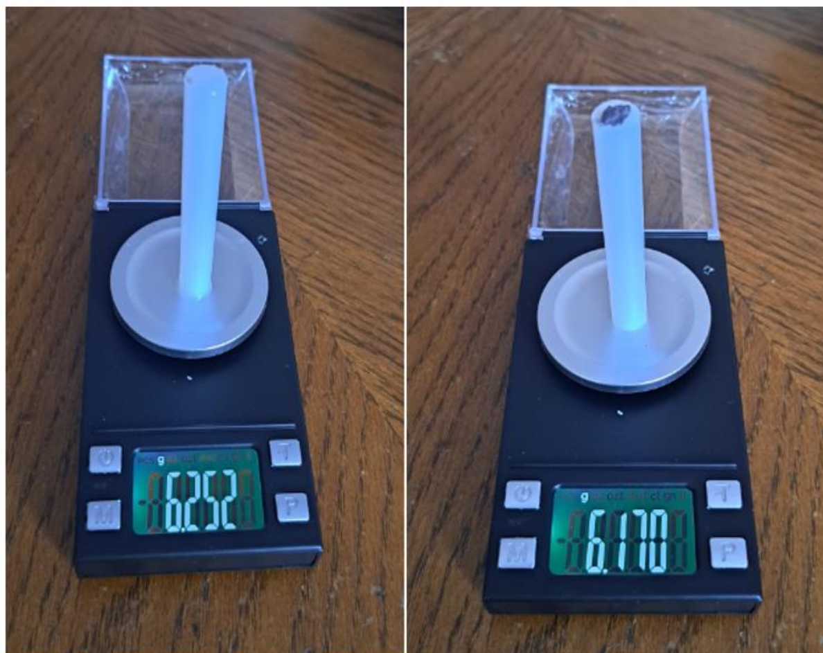
Slika 12 Rezultati mjerenja poliamida PA 6 devetog dana
