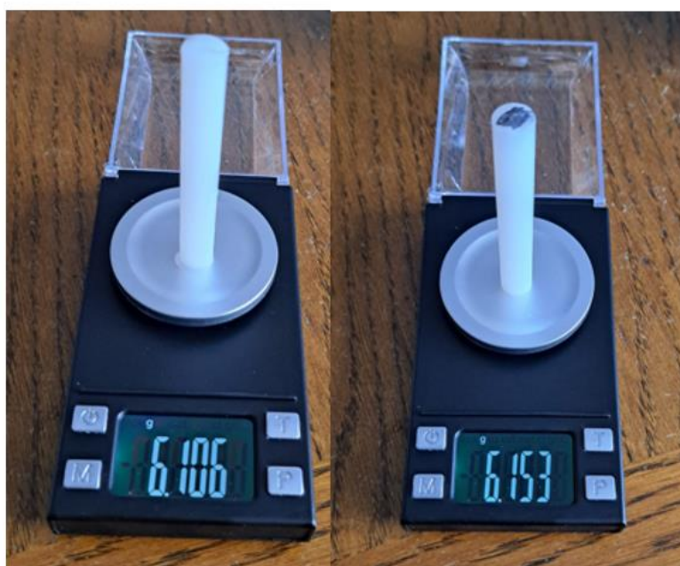
Slika 7 Rezultati mjerenja poliamida PA 6 prvog dana
