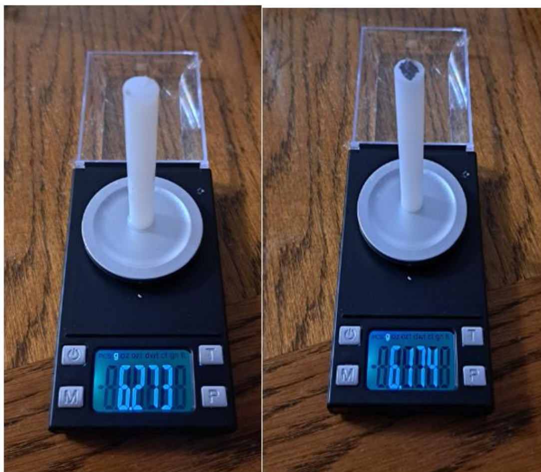
Slika 13 Rezultati mjerenja poliamida PA 6 četrnaestog dana
