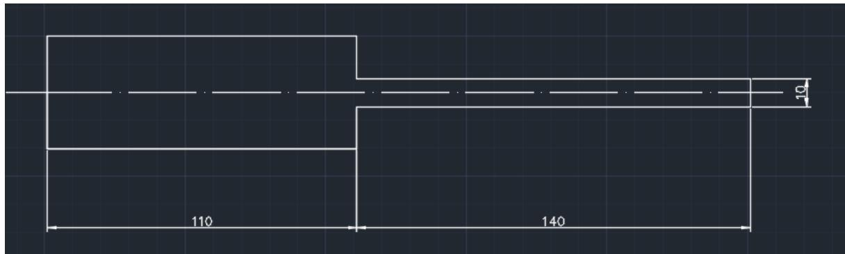
Slika 5 Dimenzije materijala poliamida PA 6 nakon obrade tokarenja
