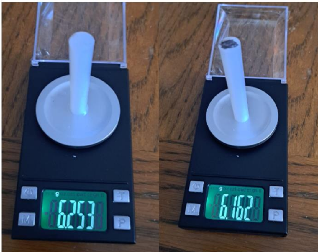
Slika 11 Rezultati mjerenja poliamida PA 6 sedmog dana
