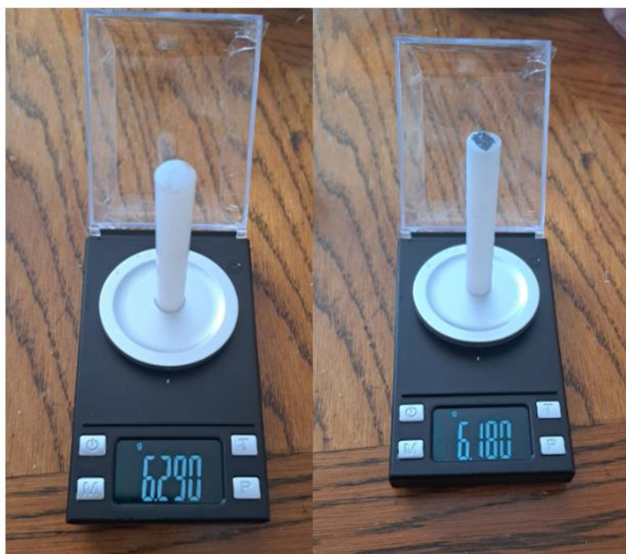
Slika 14 Rezultati mjerenja poliamida PA 6 dvadeset i prvog dana
