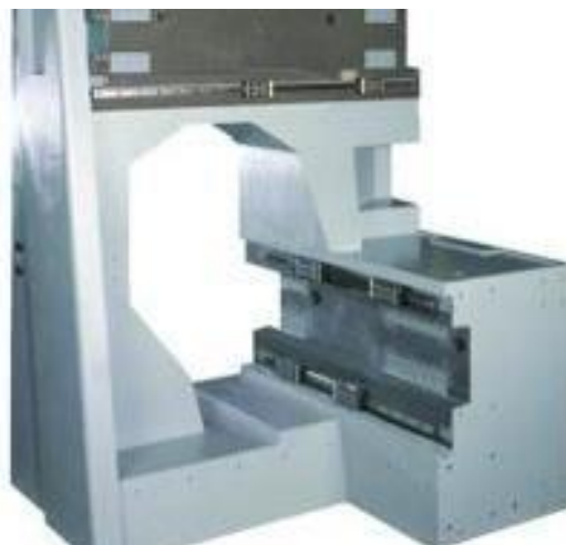
Slika 4.1. Konstrukcija stroja od polimernog betona
