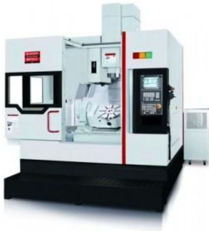
Slika 6.4. 5 - osni glodaći obradni centar
