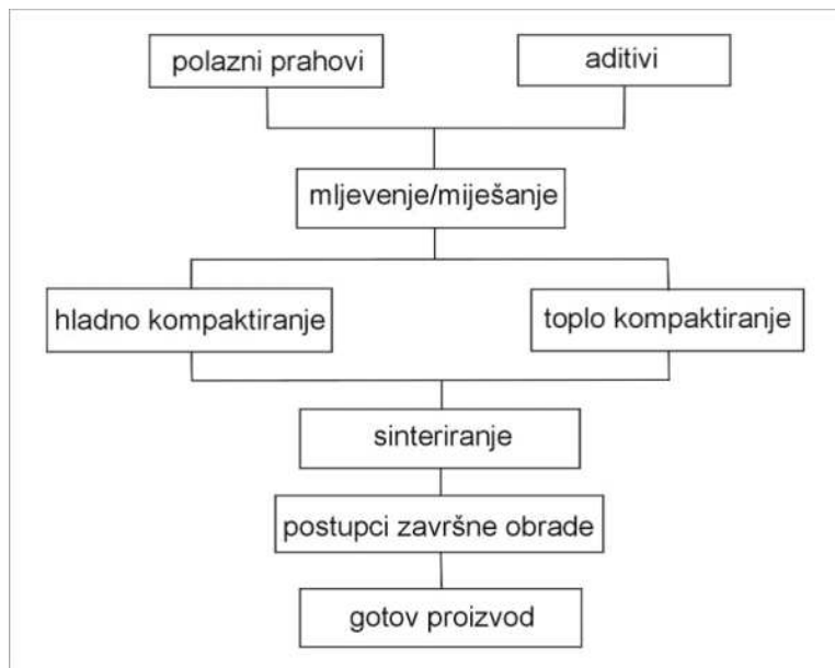
Slika 115. Hodogram tehnoloških operacija konvencionalnih postupaka metalurgije praha [11]
