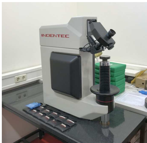
Slika 17. Indentec referentni etalon tvrdoće
