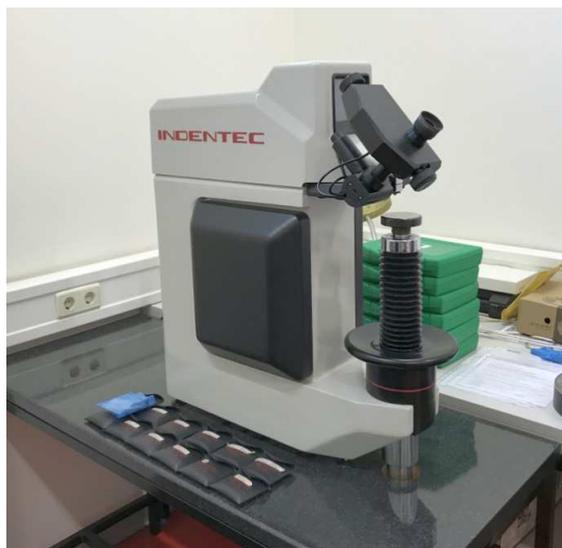
Slika 17. Indentec referentni etalon tvrdoće
