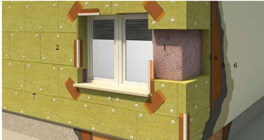
Slika 8. Zvučna i toplinska izolacija vanjskog zida građevine. Nosivi zid (1), ploča od kamena (2), Građevinsko ljepilo (3), Mrežica (4), Građevinsko ljepilo(5), Završni sloj(6), Tiple (7), Zona prskanja izoliranim ekstrudiranim polistirenom (8) (DELTAPLUS, 2020)
