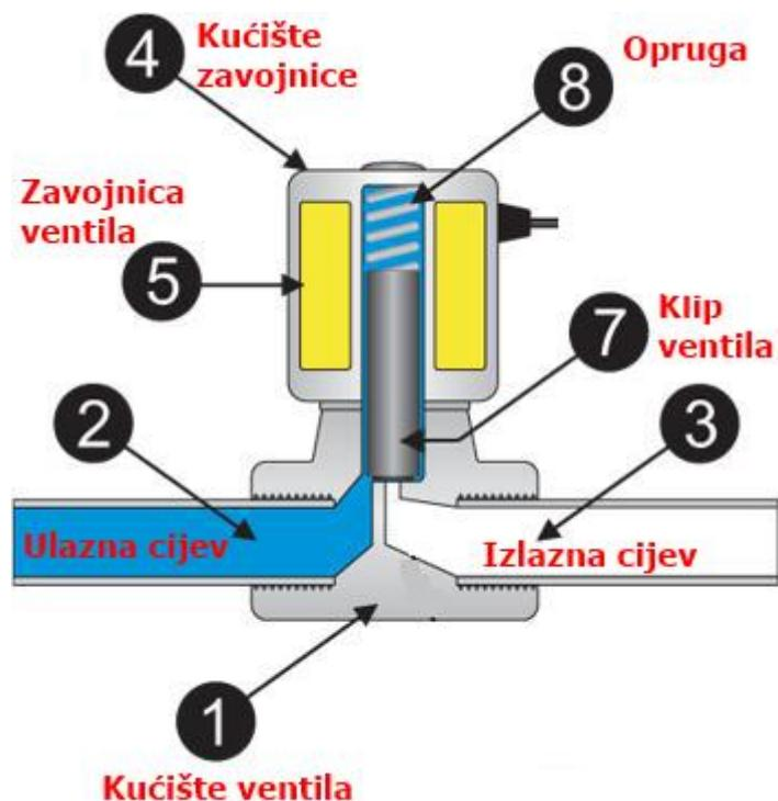
Slika 3.1. Elektromagnetski ventil [15].
