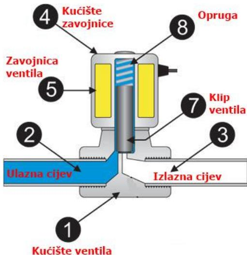
Dijelovi elektromagnetskog ventila: 1. kućište ventila, 2. Ulagana cijev vode, 3. Izlagana cijev vode, 4. Kućište zavojnica, 5. zavojnica ventila, 7. Klip ventila, 8. Opruga
