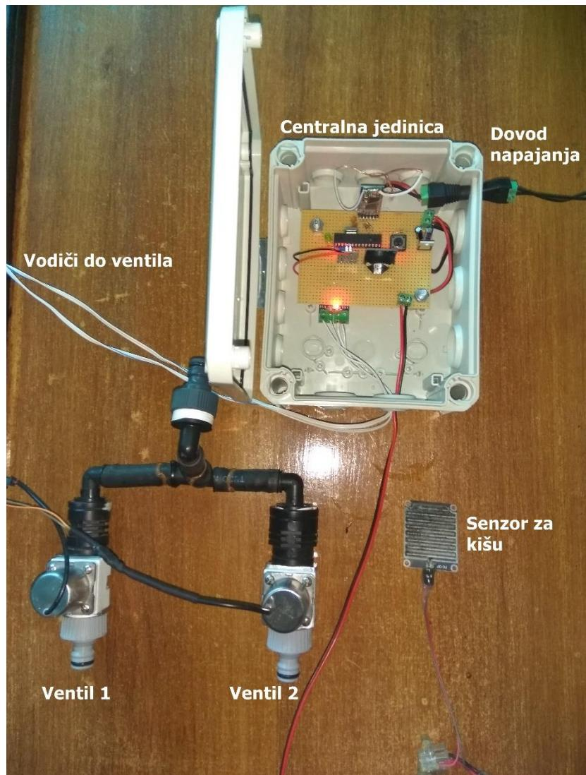
Slika 5.1 Prototip mobilno upravljanog sustava za navodnjavanje
