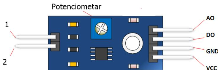
Slika 3.3 Modul senzora kiše [17].
