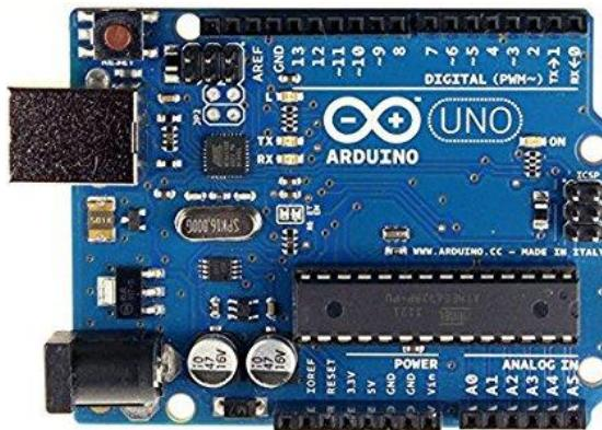
Slika 3.6 Arduino UNO mikrokontroler [20].
