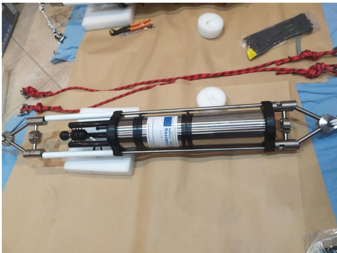
**Slika 4. Hidrofon – podvodni mikrofon – služi za snimanje podvodnih zvukova. Izvor**
