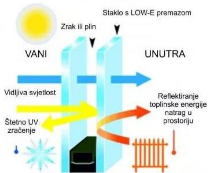
Slika 13. Prikaz utjecaja LOW-E premaza na IZO staklu [2].
