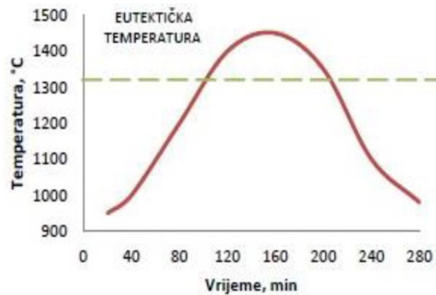
Slika 22: Prikaz karakterističnog ciklusa vrijeme -temperatura sinteriranja u atmosferi vodika WC – Co tvrdih metala [4]
