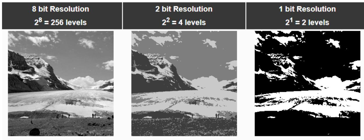
Slika 7. Usporedba radiometrijske rezolucije (Earth Observing System, 2019.).
