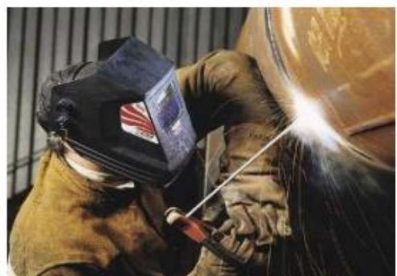
Slika 4.1a. Shematski prikaz REL zavarivanja
