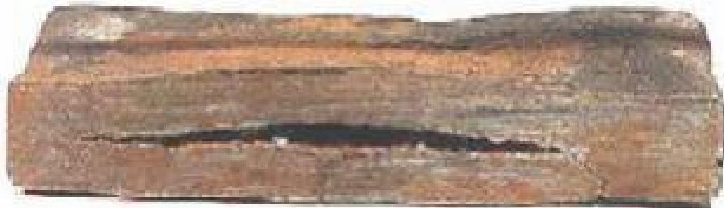
Slika 2.2. Vodikova bolest ugljičnog čelika
