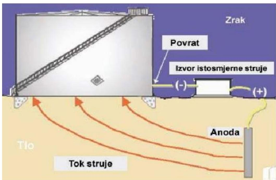
Slika 7.3. Katodna zaštita uz vanjski izvor struje [17]
