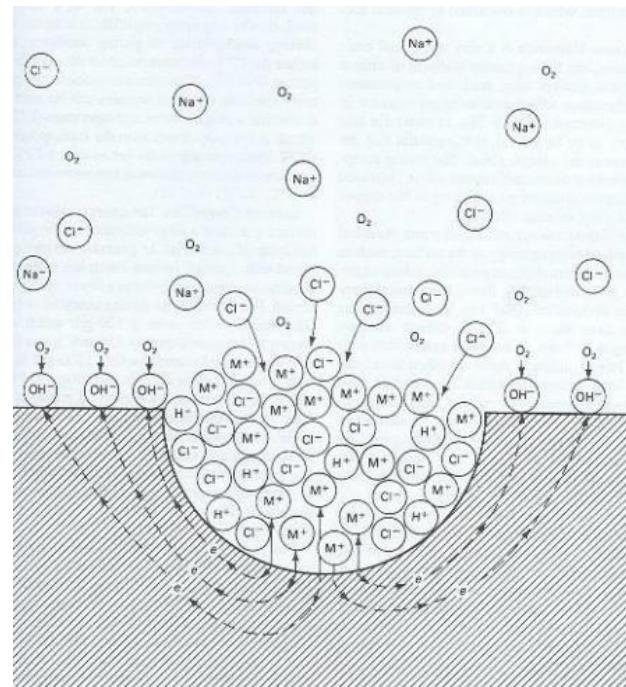
Slika 5.4. shematski prikaz rupičaste korozije [15]
