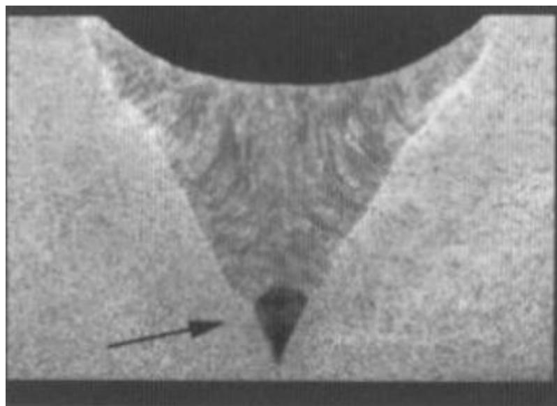
Slika 3.8. Uključak troske kod MAG postupka zavarivanja [8]
