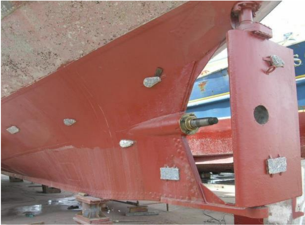
Slika 7.4. Žrtvene Anode na brodu [5]
