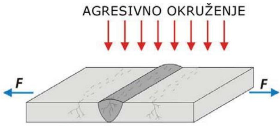
Slika 5.12. Nastanak napetosne korozije [17]
