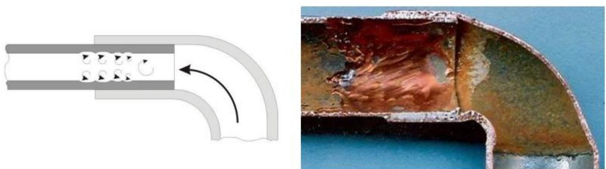
Slika 5.11. Erozija korozija bakrenog cjevovoda [16]
