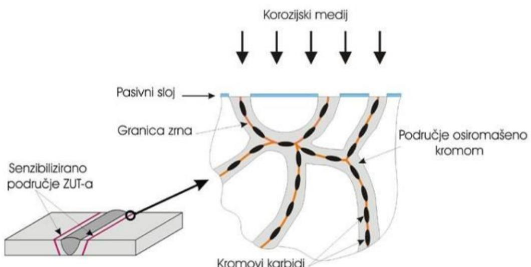
Slika 5.6. Shematski prikaz nastanka interkristalne korozije [16]
