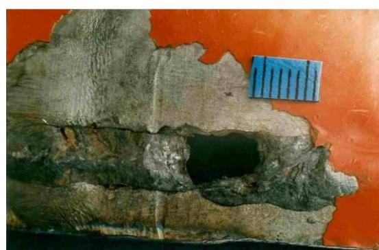
Slika 5.9. Stvarni prikaz oštećenja selektivnom korozijom [16]
