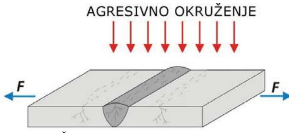
Slika 5.12. Nastanak napetosne korozije [17]
