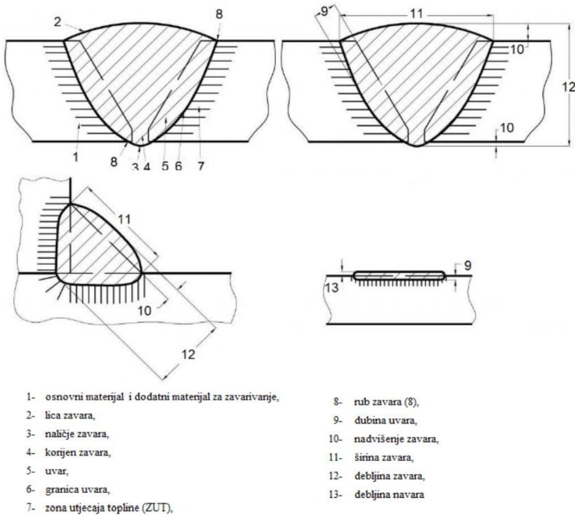
Slika 2.2. Osnovni elementi zavarenog spoja [1]
