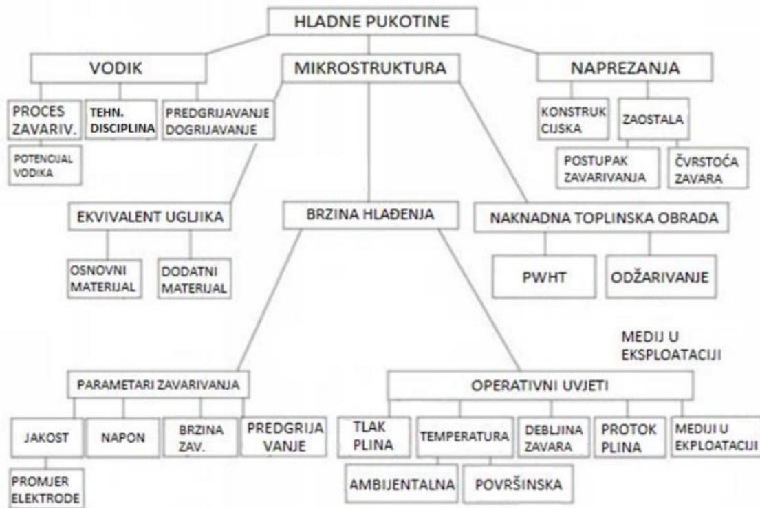
Slika 3.4. Shematski prikaz utjecajnih faktora na nastanak hladnih pukotina [6]
