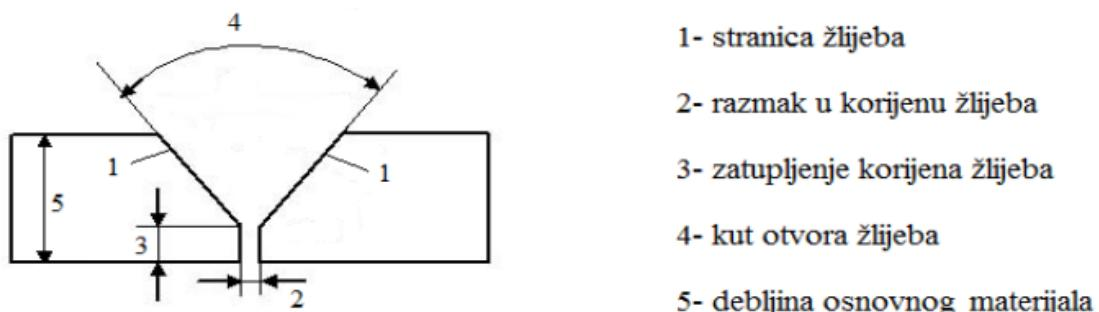
Slika 2.1. Priprema za zavarivanje [1]
