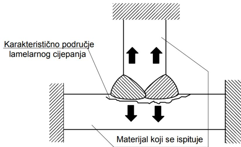
Slika 3.6. Lamelarne pukotine u zavarenom spoju [4]
