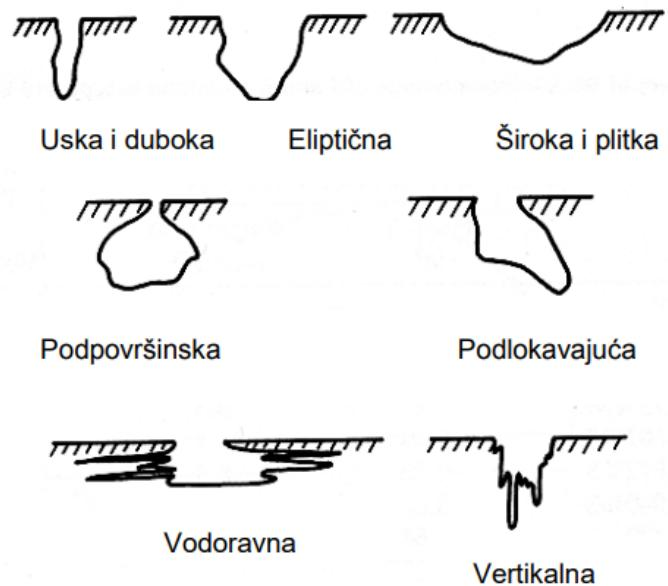
Slika 5.5. Mogući oblici rupičaste korozije [15]
