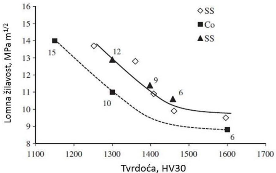
Slika 5.15 Usporedba mehaničkih svojstava WC-AISI304 i WC-Co [36]
