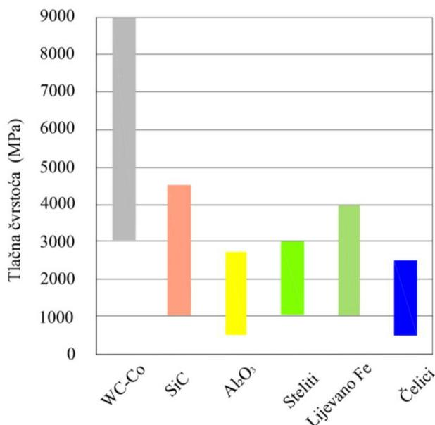
Slika 4.4 Tlačna čvrstoća tvrdog metala u usporedbi s drugim materijalima [48]
