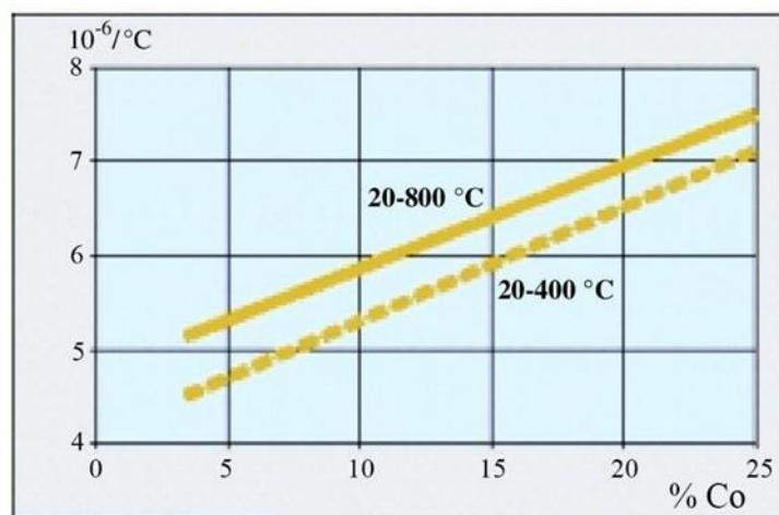
Slika 4.6 Ovisnost koeficijenta linearног toplinskog rastezanja o udjelu materijala matrice [15]
