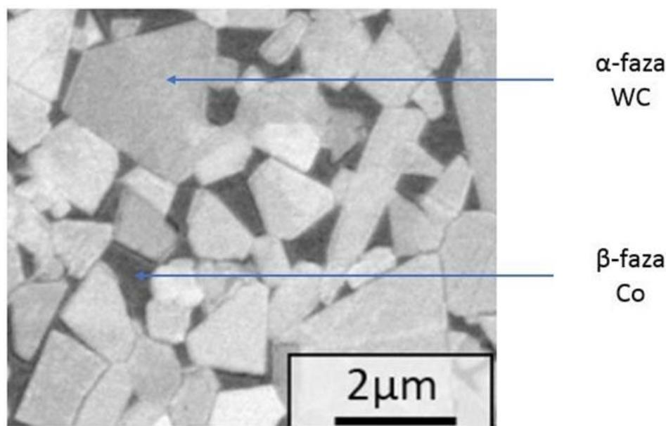
Slika 2.2 Dvofazna mikrostruktura WC-Co tvrdog metala [6]
