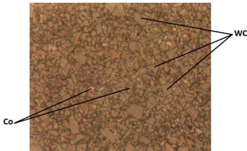
Slika 1.1 Mikrostruktura nanostrukturiranog tvrdog metala WC – Co
