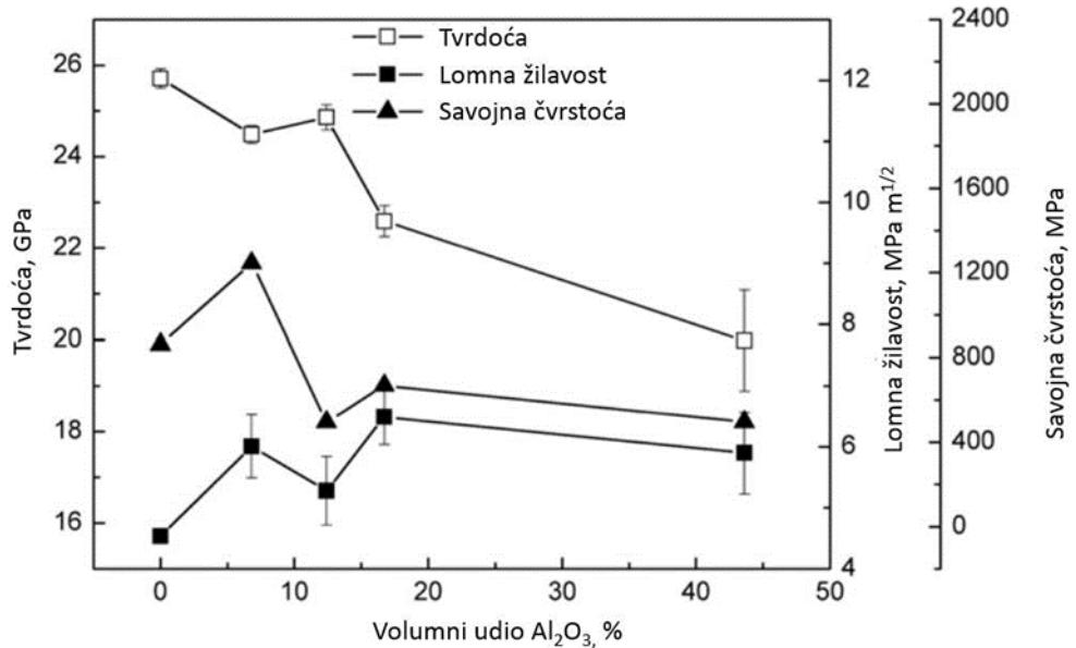
Slika 5.20 Ovisnost mehaničkih svojstava WC- $\text{Al}_2\text{O}_3$  tvrdih metala o volumnom udjelu veziva [41]
