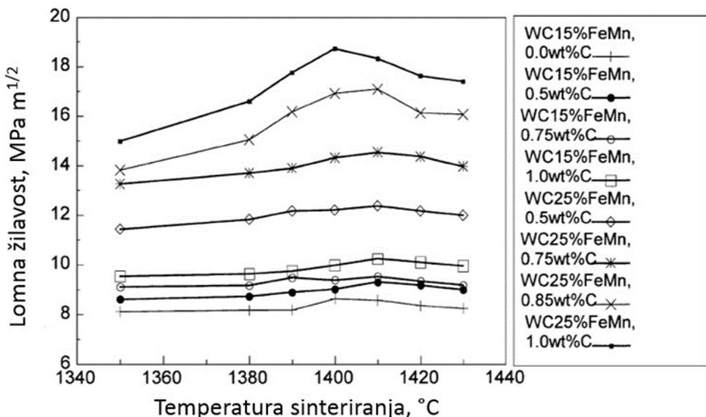
Slika 5.12 Rezultati ispitivanja lomne žilavosti WC-Fe-Mn tvrdih metala u ovisnosti o temperaturi sinteriranja i masenom udjelu dodatka ugljika [34]
