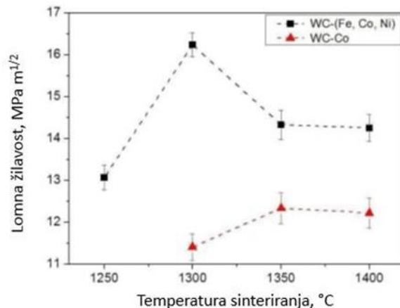
Slika 5.10 Usporedba lomne žilavosti nanostrukturiranih WC-Fe-Ni-Co i WC-Co [30]
