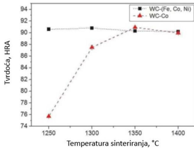
Slika 5.8 Usporedba tvrdoće nanostrukturiranih WC-Fe-Ni-Co i WC-Co [30]
