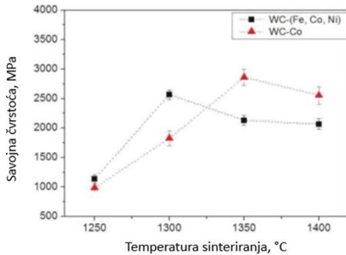
Slika 5.9 Usporedba savojne čvrstoće nanostrukturiranih WC-Fe-Ni-Co i WC-Co [30]
