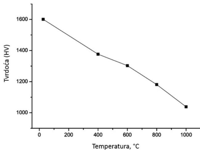
Slika 2.5 Utjecaj temperature primjene na tvrdoču tvrdih metala [7]
